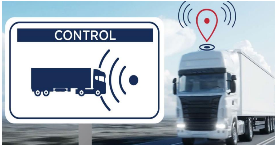
Slika 14: Očitavanje podataka iz pametnog tahografa bez zaustavljanja vozila
