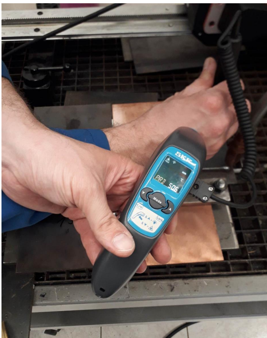
Slika 40. Mjerenje međuprolazne temperature pojedinih prolaza
