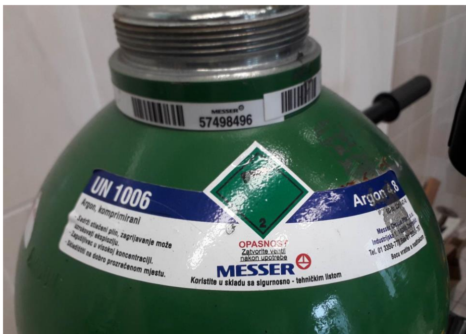
Slika 27. Oznaka na boci zaštitnog plina korištenog u eksperimentu
