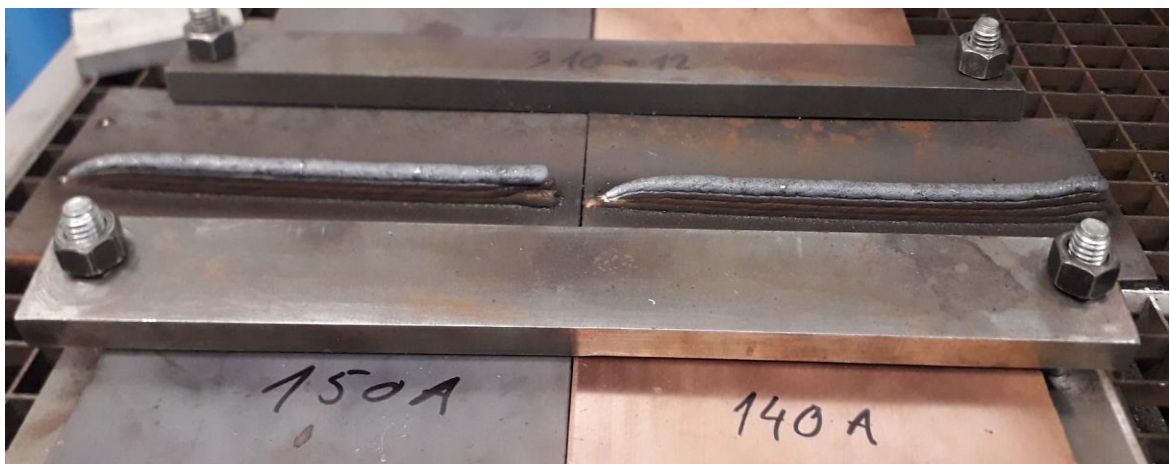
Slika 35. Uzorci zidova s četiri navarena sloja
