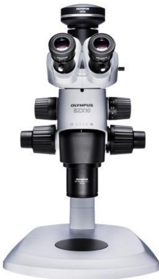
Slika 24. Stereomikroskop Olympus SZX10 [53]
