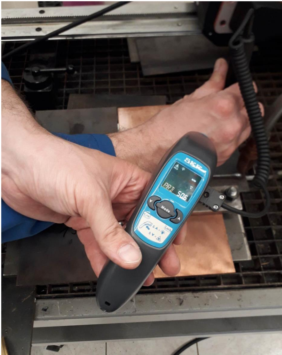
Slika 40. Mjerenje međuprolazne temperature pojedinih prolaza
