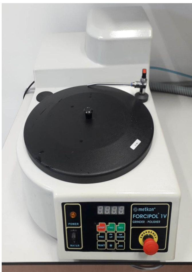
Slika 23. Uređaj za brušenje i poliranje Metkon Forcipol 1V Grinder & Polisher
