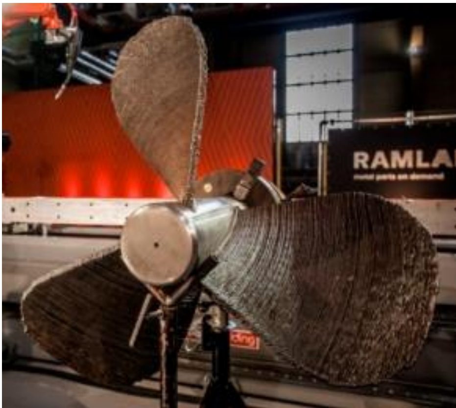
Slika 14. Propeler s tri lopatice izrađen WAAM postupkom [36]
