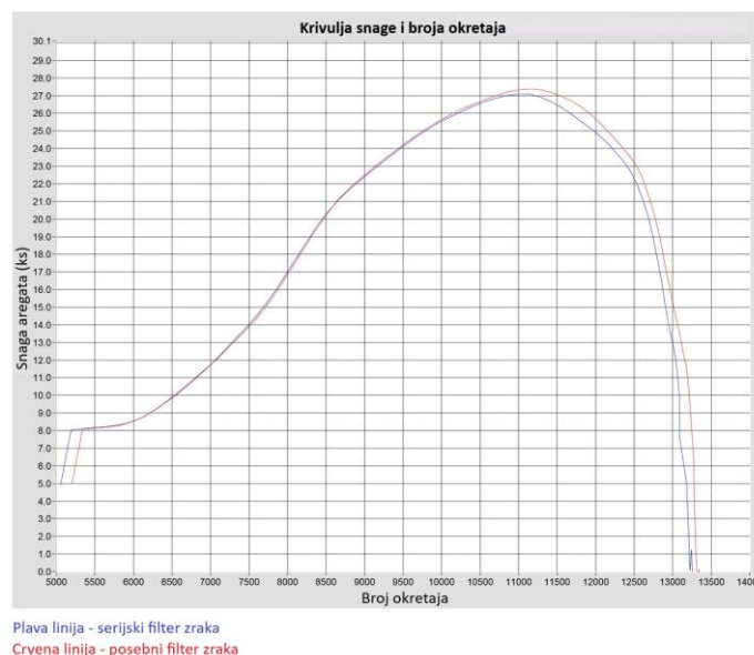
Slika 5.5 Graf snage i okretaja (plava linija – motocikl sa serijskim dijelovima KTM SX 85)[25]
