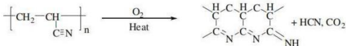
Slika 19 – Proces oksidacije kojim nastaju šesterokutni prsteni [14]
