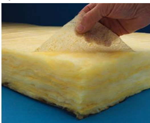
Slika 16 – Staklena vuna kao toplinski izolator [29]
