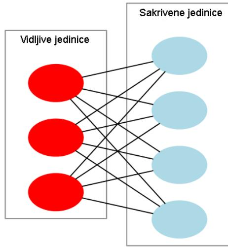
Slika 4.4 Dijagram ograničenog Boltzmann-ovog stroja s tri vidljive jedinice i četiri skrivene jedinice
