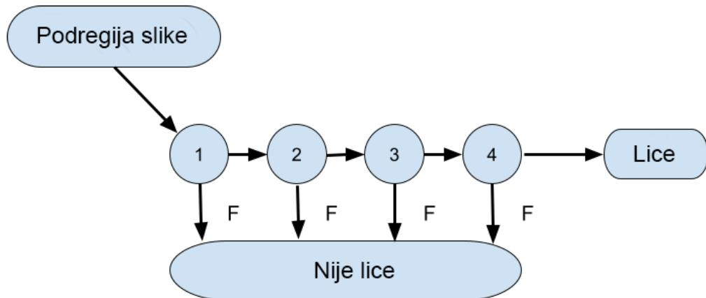
Slika 3.4 Shema kaskadnog klasifikatora
