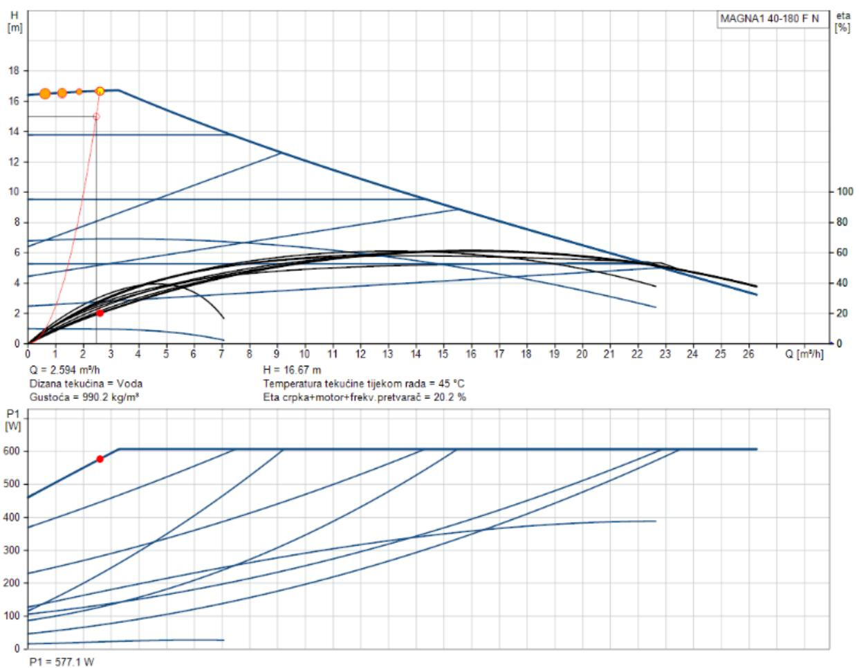
Slika 15. Karakteristika i radna točka pumpe magnaI 40-180 FN [22]
