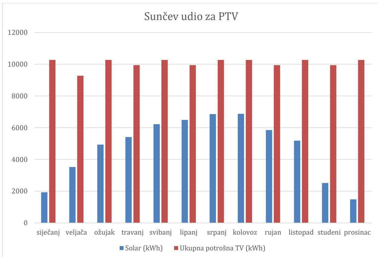
Slika 12. Grafički udio solarni sustava za pripremu PTV-a
