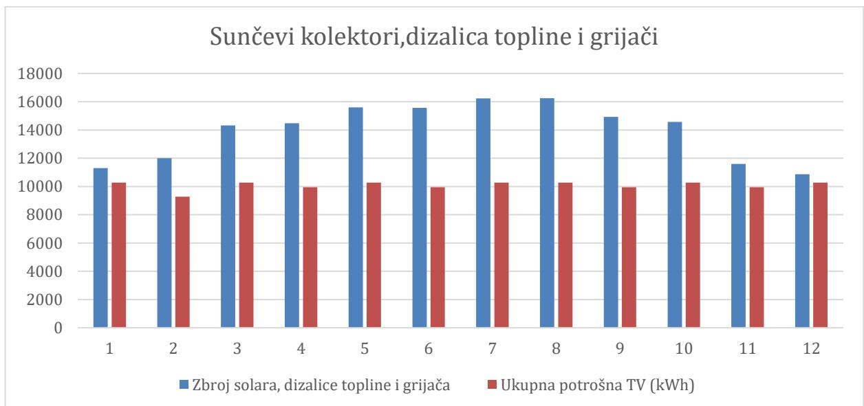
Slika 21. Grafički udio sunčevih kolektora, dizalice topline i električnih grijaca za pripremu tople vode
