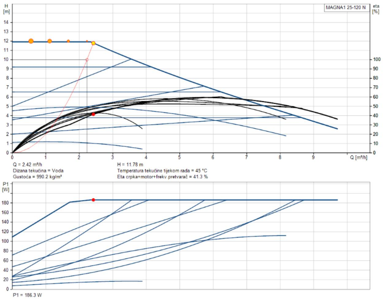
Slika 24. Karakteristika i radna točka pumpe magna1 25-120 N [22]
