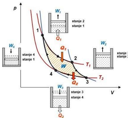
Slika 6. Prikaz teoretskog lijevokretnog Carnotovog procesa u p-v i T-s dijagramima
