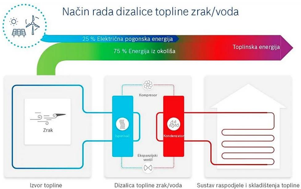
Slika 8. Shematski prikaz rada dizalice topline zraka zrak-voda [16]
