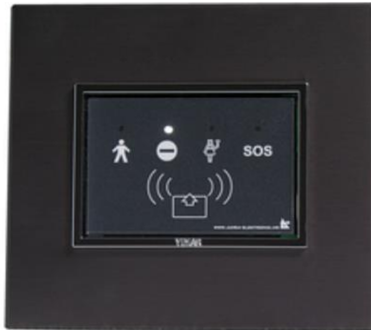
Slika 3.3 Modul vanjskog čitača kartice [3]
