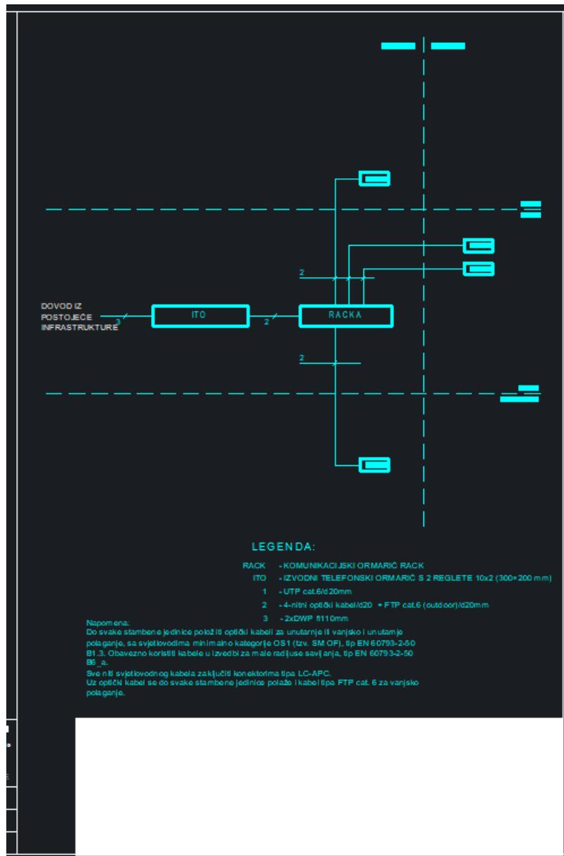
Slika 6.4 Blok shema LAN instalacije
