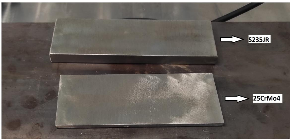
Slika 6.1. Ispitni uzorci prije provođenja eksperimenta
