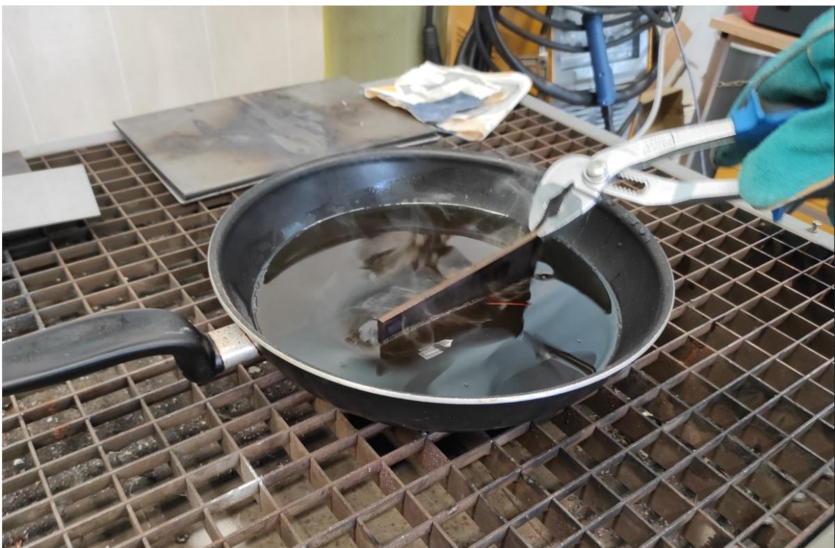
*Slika 6.7. uranjanje zagrijane pločice u ulje*
