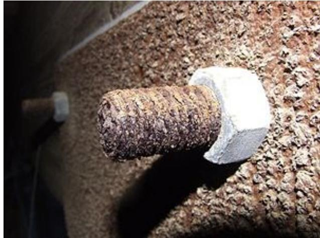
*Slika 2.10. Prikaz galvanske korozije između vijka i matice [12]*
