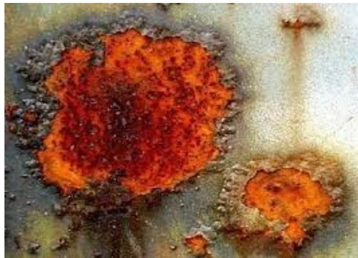
Slika 2.9. Prikaz površinske korozije [11]
