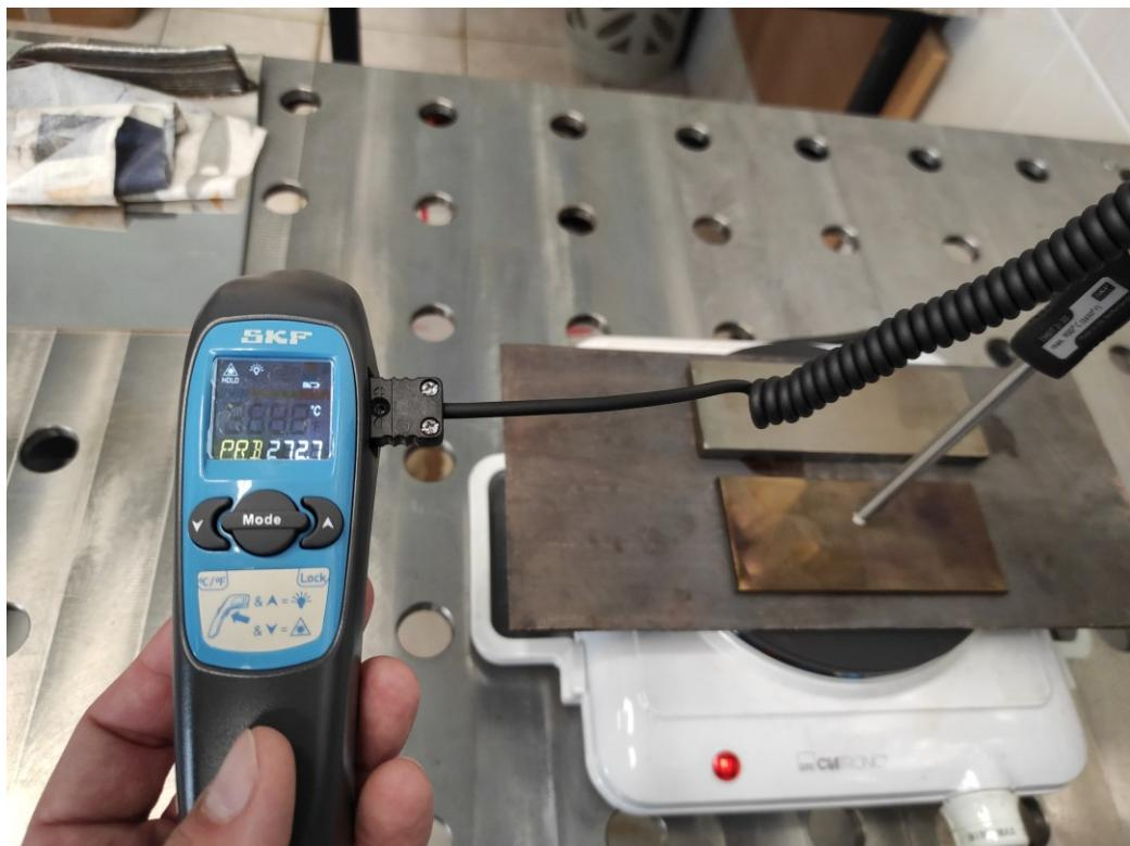
Slika 6.6. Zagrijavanje pločica na temepraturu od  $300\text{ }^{\circ}\text{C}$
