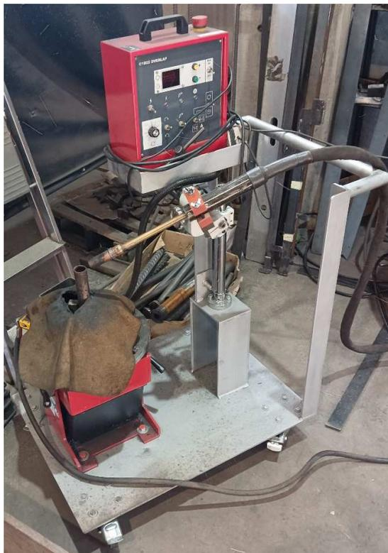
*Slika 22. Kolica sa pozicionerom i uređajem za zavarivanje*
