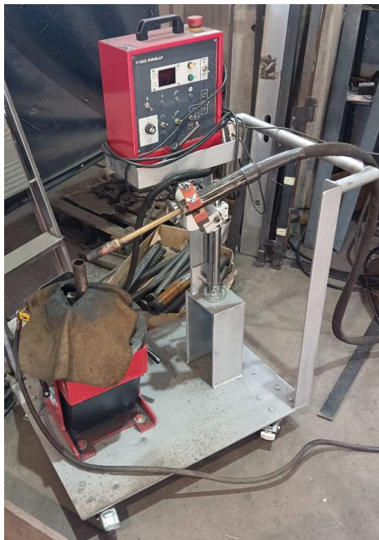
Slika 22. Kolica sa pozicionerom i uređajem za zavarivanje
