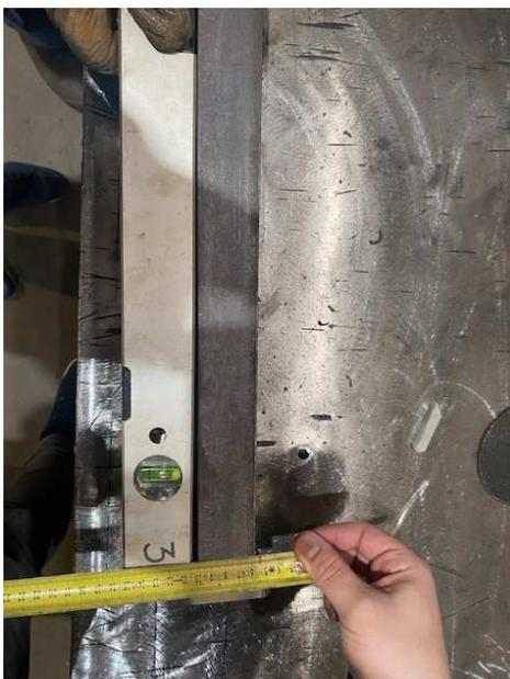
Slika 19. Mjerenje deformacije nakon zavarivanja
