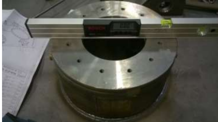
Slika 5.2: Kontrola zračnosti na prirubnicama visokonaponske strane
