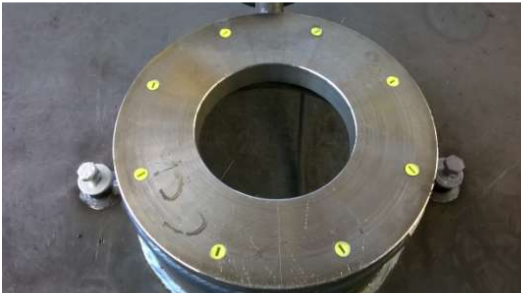
Slika 6.1: Zaštita prirubnica prije sačmarenja
