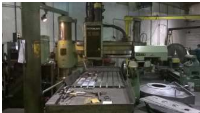
Slika 4.32: CNC glodalica Kitamura K-100
