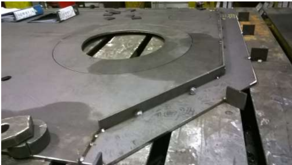
Slika 4.11: Pritezanje ploče poklopca i spajanje s okvirom
