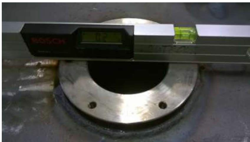
Slika 4.68: Kontrola ravnosti pomoću digitalne libele
