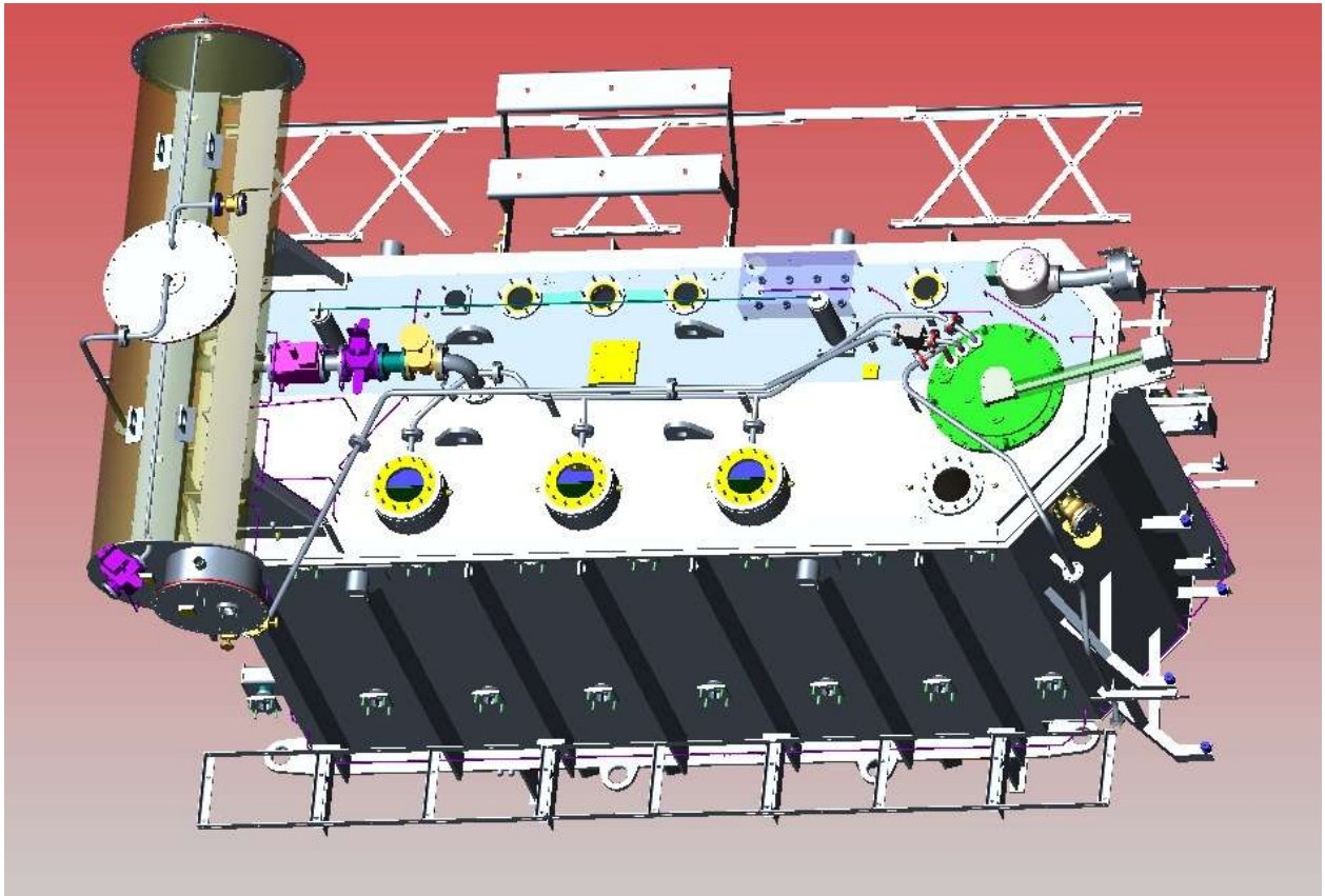
Slika 2.2: Transformator sa svim pripadajućim dijelovima, 3D crtež.
