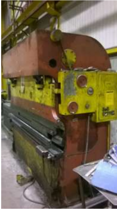
Slika 4.65: Hidraulična preša za Kutno savijanje
