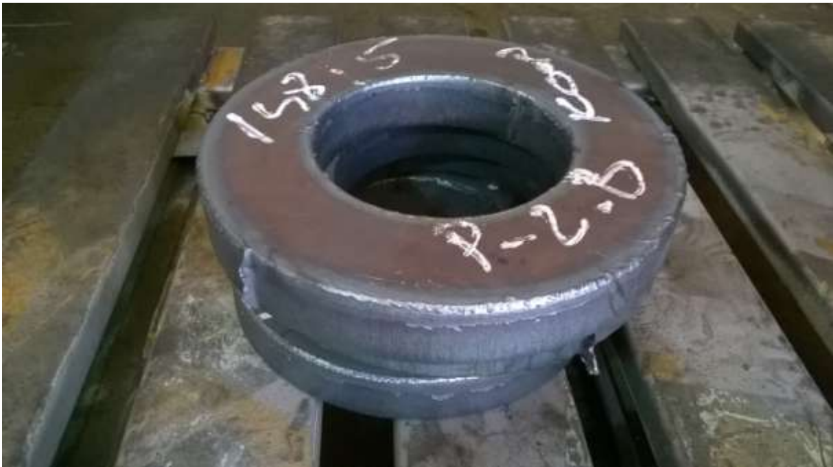
Slika 4.12: Plazmom izrezani sirovac prije obrade tokarenjem
