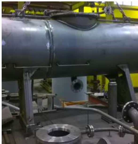
Slika 4.72: Pozicioniranje L-profila s konzervatorom
