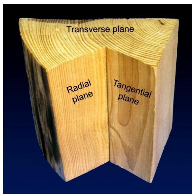
Slika 4. Prikazuje presjeke drva [12]
