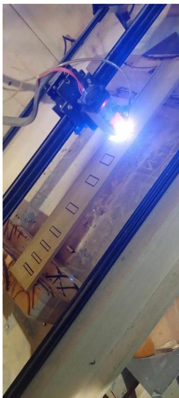
*Slika 20. Izrada Template-a za vrat gitar*
