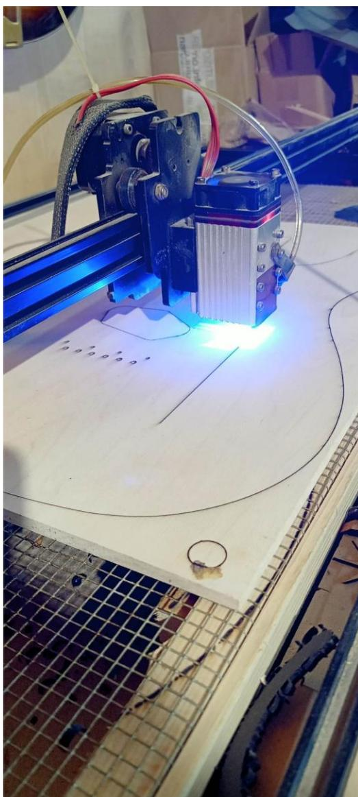
*Slika 13. Slika prikazuje lasersko rezanje drveta (template)*
