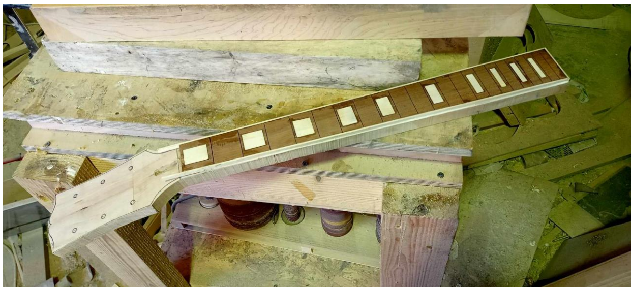
Slika 20. Izrada Template-a za vrat gitar
