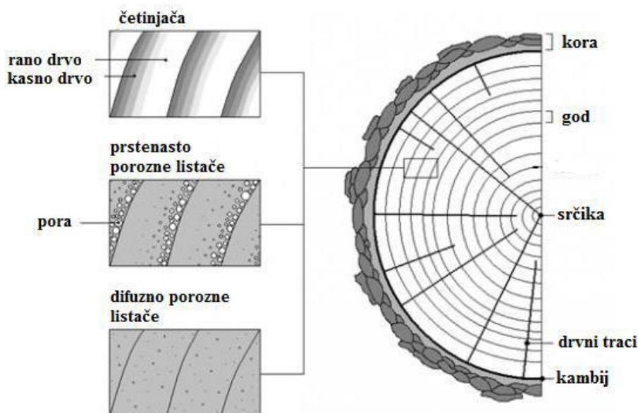
Slika 5. Prikazuje dijelove drva (poprečni presjek) [13]
