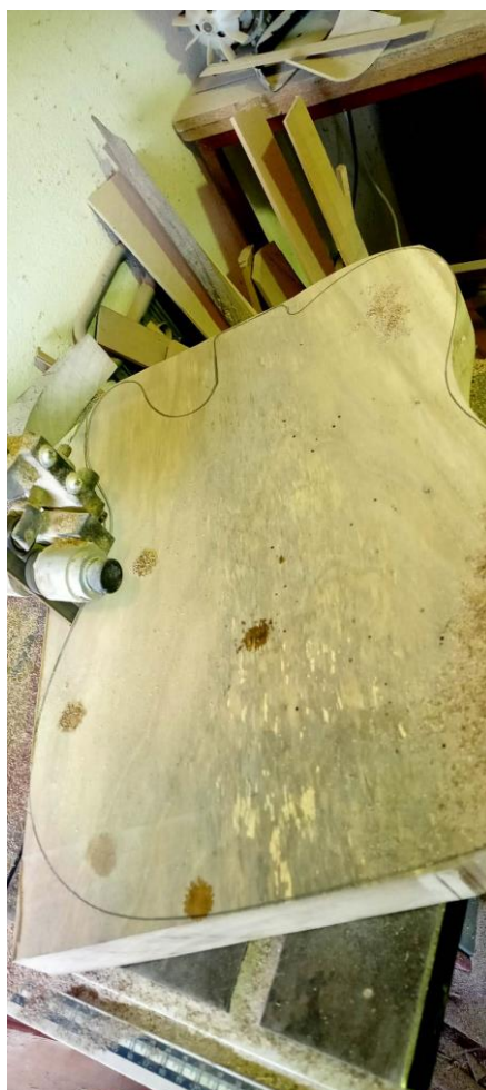
Slika 14. Prikazuje prijenos mjera iz template-a te rezanje
