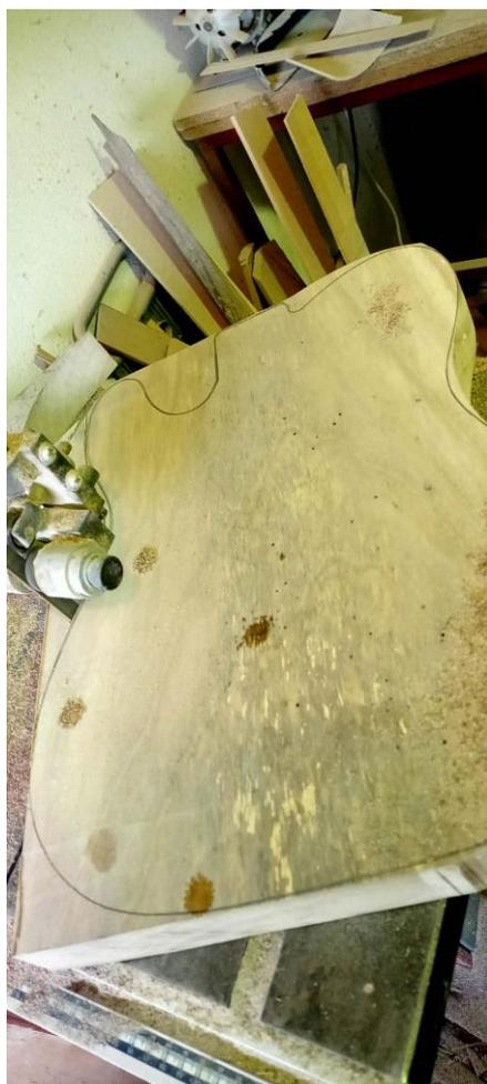
*Slika 14. Prikazuje prijenos mjera iz template-a te rezanje*
