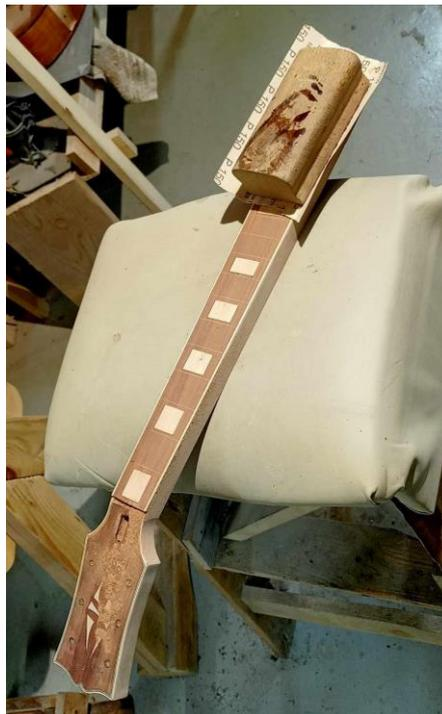
*Slika 25. Brušenje vrata gitare*
