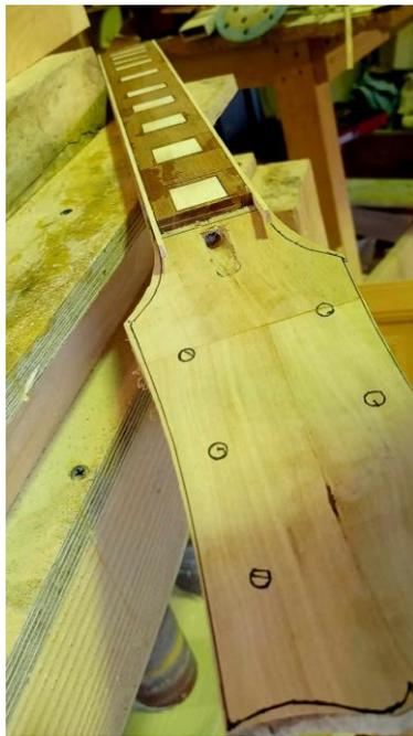
*Slika 23. Vrat gitare sa truss rod-om*
