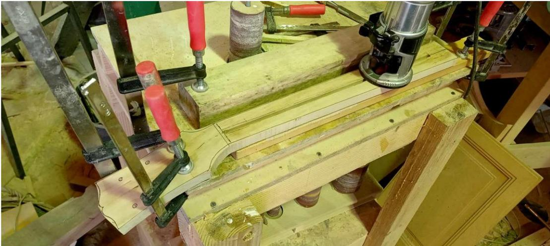
*Slika 22. Glodanje utora za truss rod*
