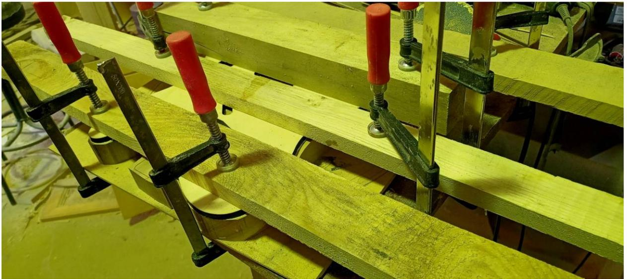
*Slika 16. Fiksiranje kritičnih dijelova gitare.*
