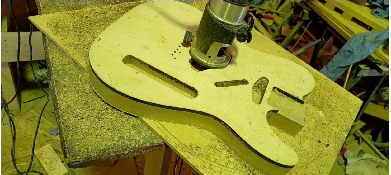
Slika 18. Prikazuje glodanje utora
