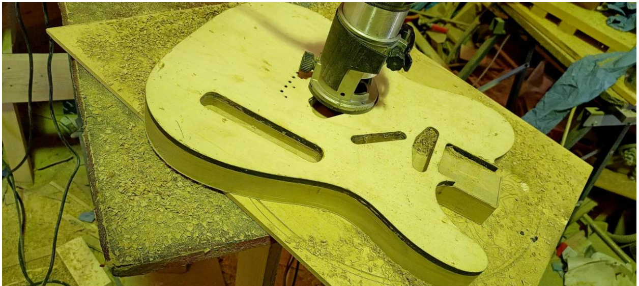
Slika 18. Prikazuje glodanje utora
