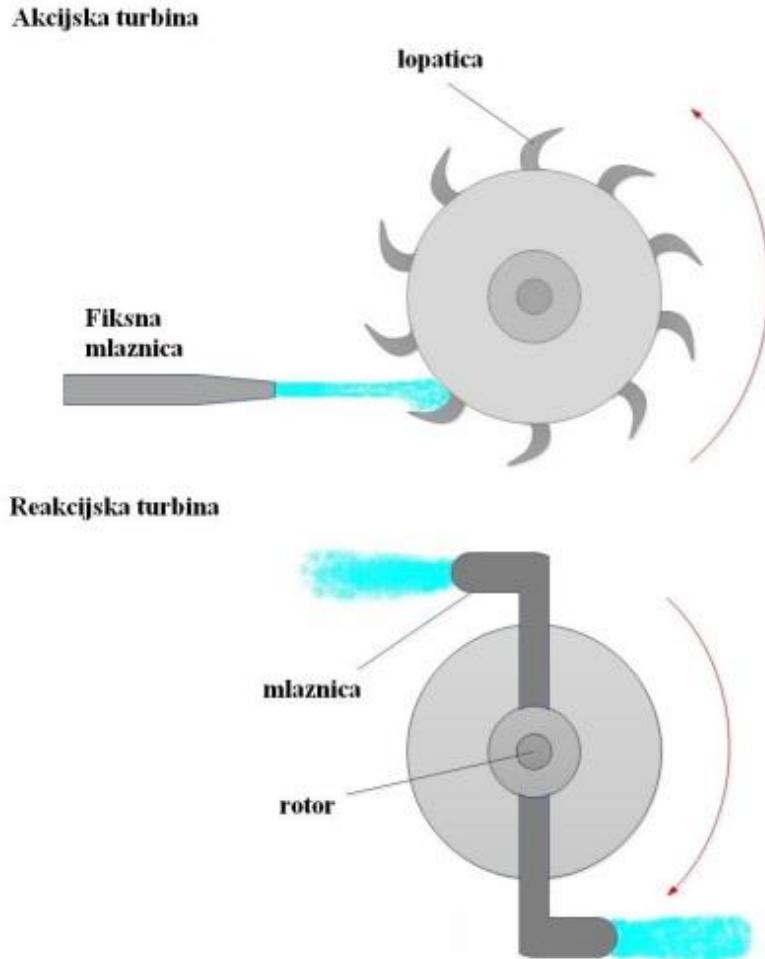
Slika 3.4. princip vrtnje akcijske i reakcijske turbine [17]
