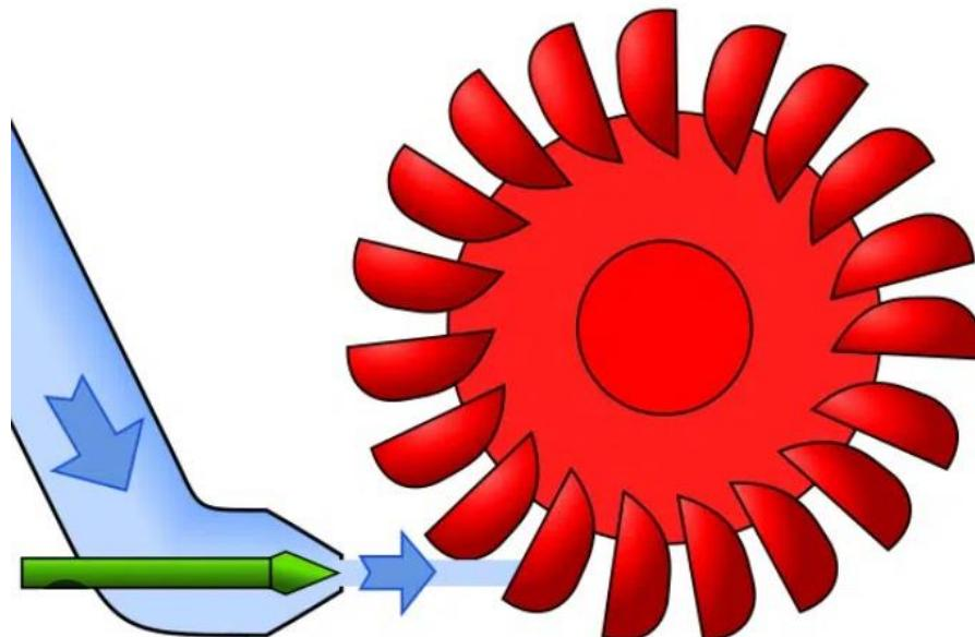
Slika 3.7. Peltonova turbina [20]
