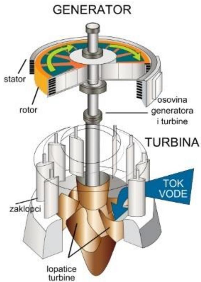
Slika 3.5. Kaplanova turbina i električni generator u presjeku [18]
