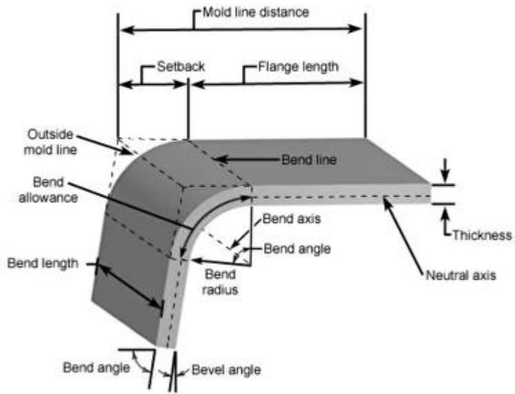
Slika 9. Prikaz parametara savijanja iz formule 1 (1)(9)
