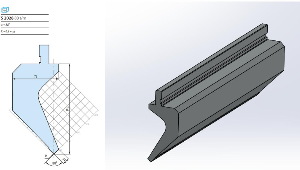
Slika 13. Prikaz noža(3D model i katalog)(2)(4)
