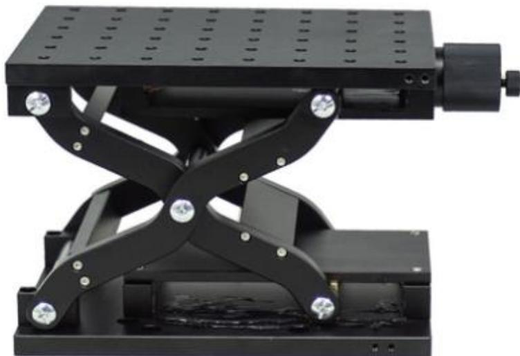
Slika 20. Škarasti mehanizam podizanja(2)(11)
