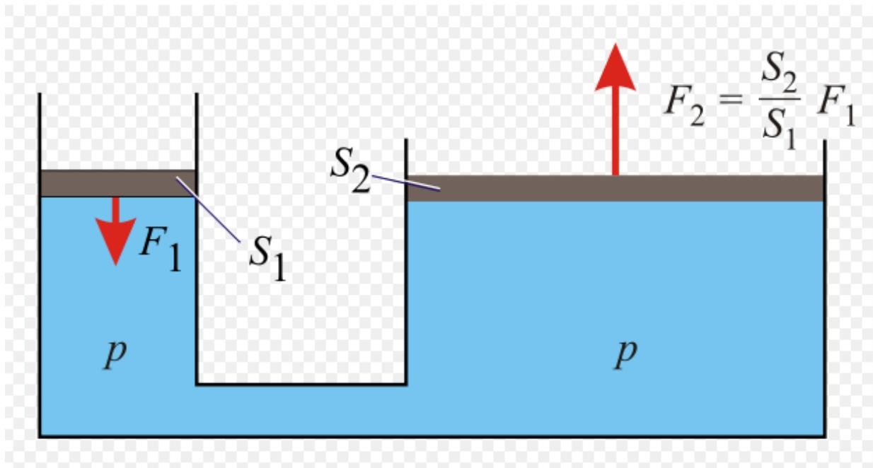
Slika 1. – Pascal-ov zakon i princip rada hidrauličke preše(1)(1)
