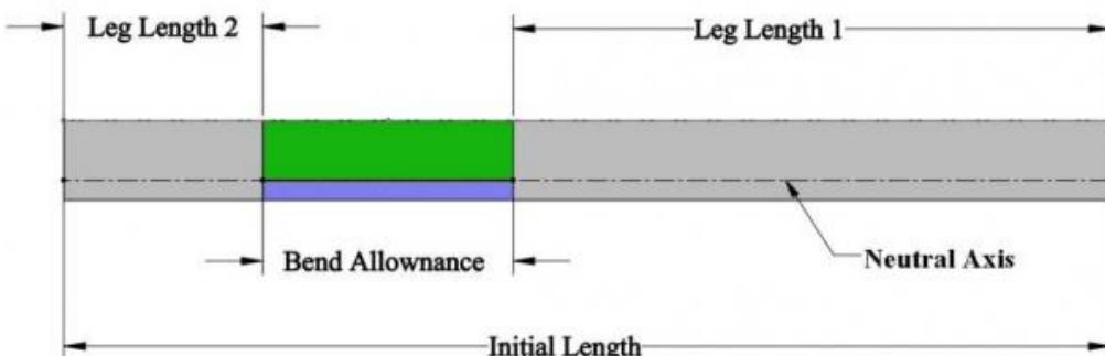
Slika 8. Prikaz razvijene duljine materijala prije savijanja(1)(8)
