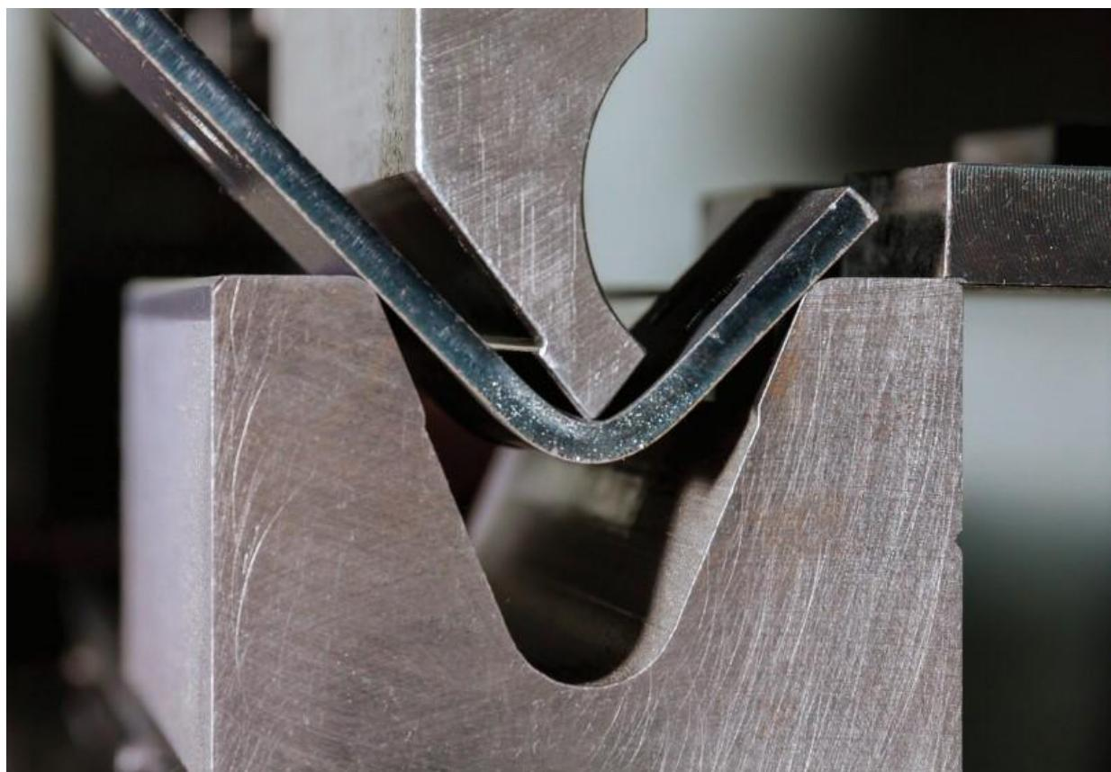
Slika 6. Prikaz alata u procesu deformacije(1)(6)
