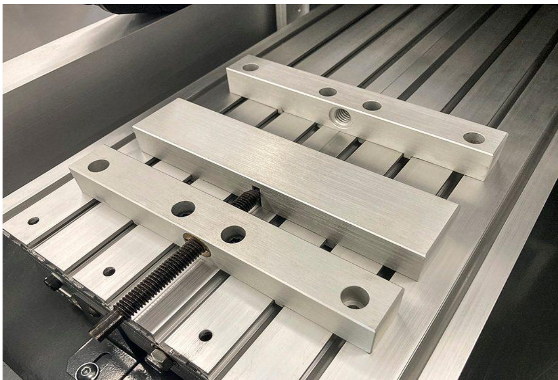
Slika 4.2 Stezna naprava za stezanje obratka [15]
