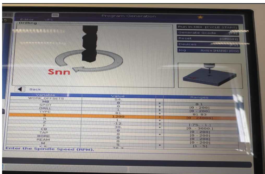
Slika 4.18 Varijabla za određivanje broja okretaja vretena
