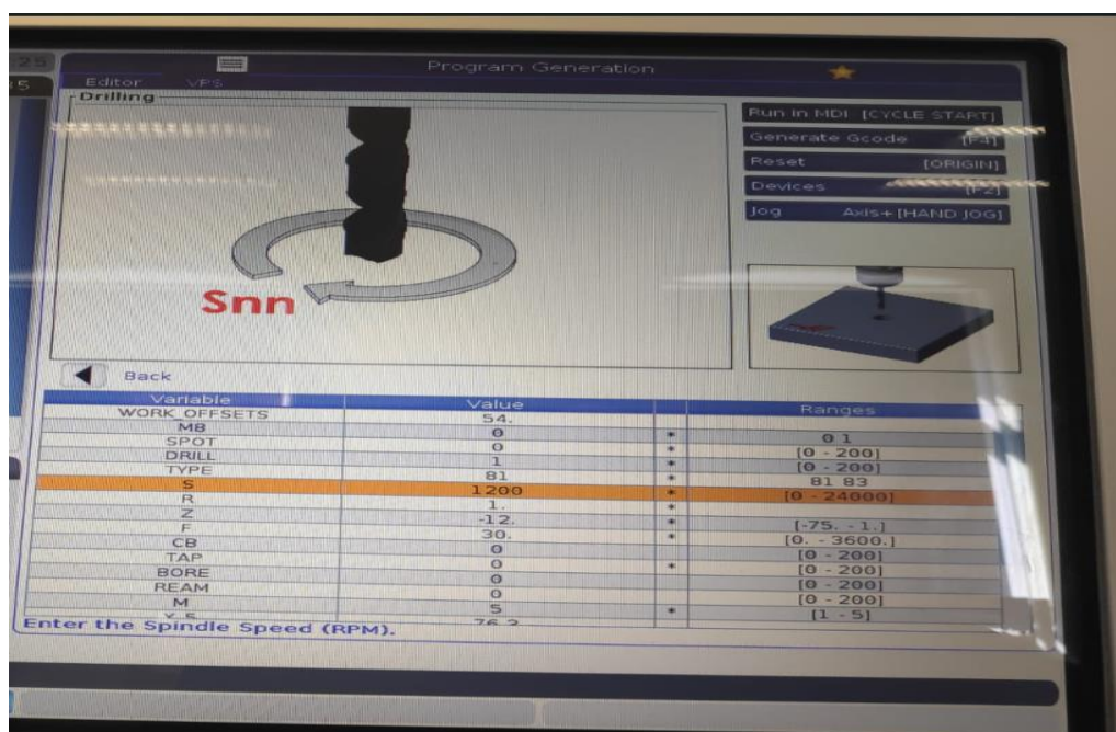
Slika 4.18 Varijabla za određivanje broja okretaja vretena
