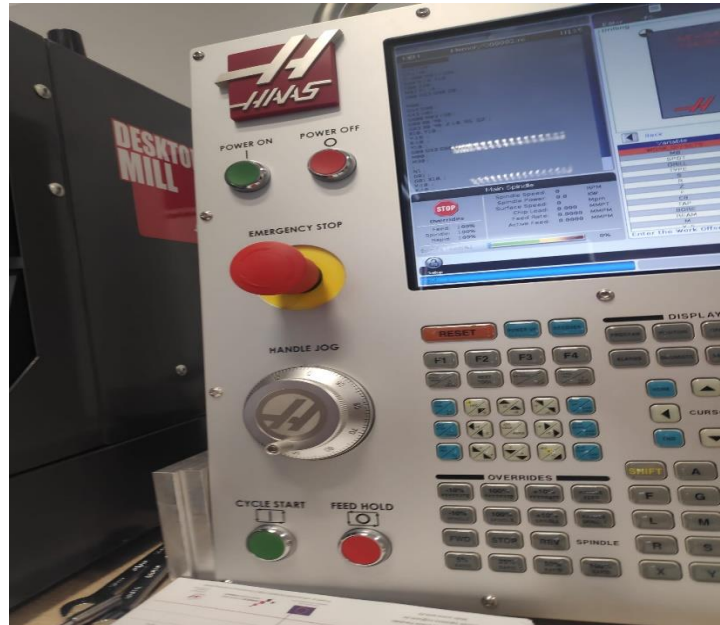
Slika 4.9 Kolo za ručno pomicanje vretena
