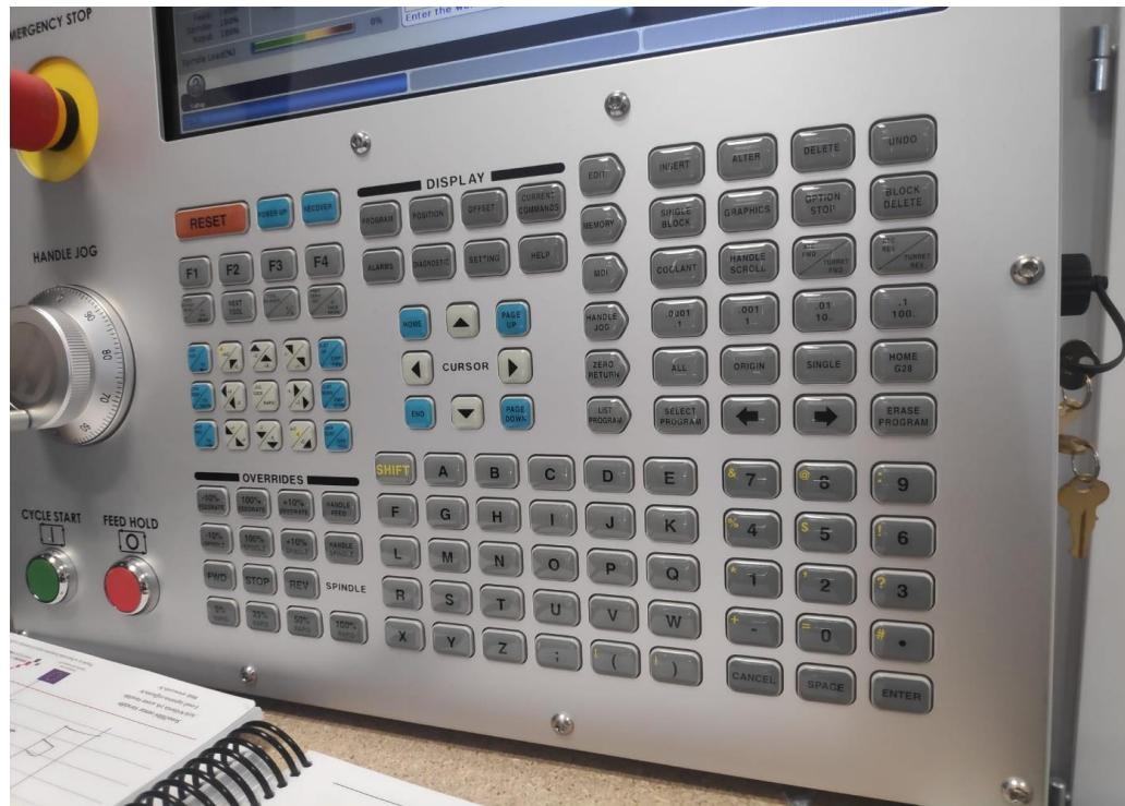
Slika 4.6 Tipkovnica upravljačke jedinice
