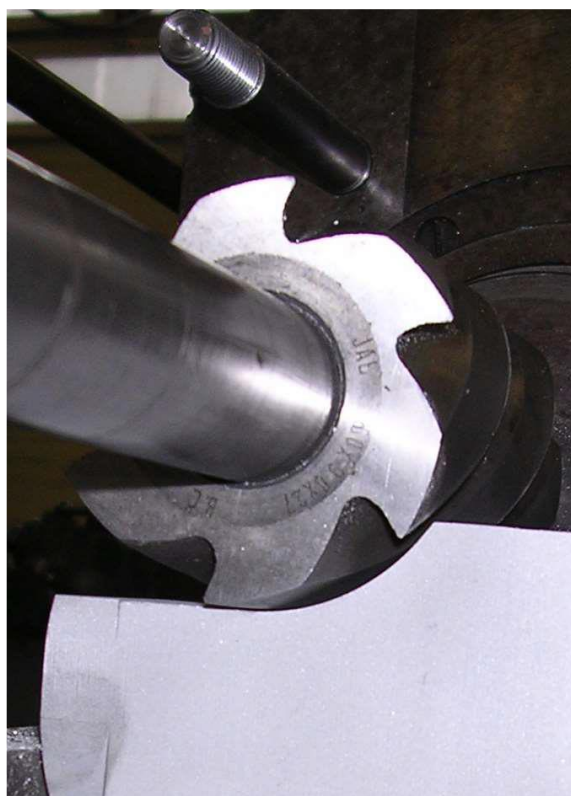
Slika 2.2 Istosmjerno obodno glodanje [2]
