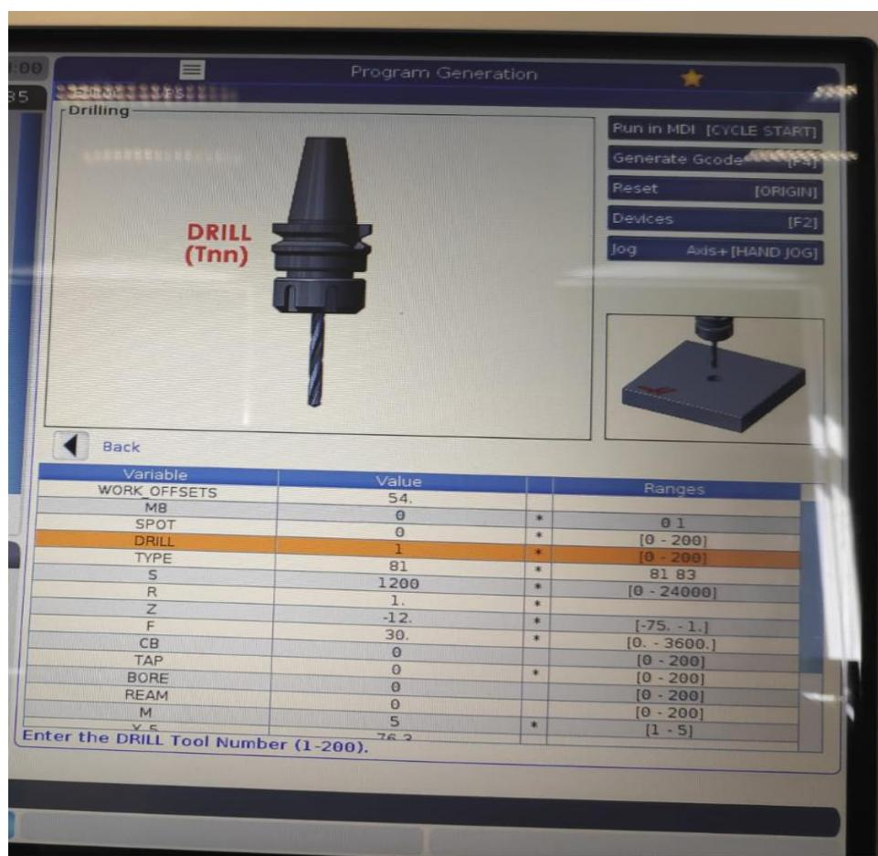
Slika 4.16 Odabir alata za bušenje
