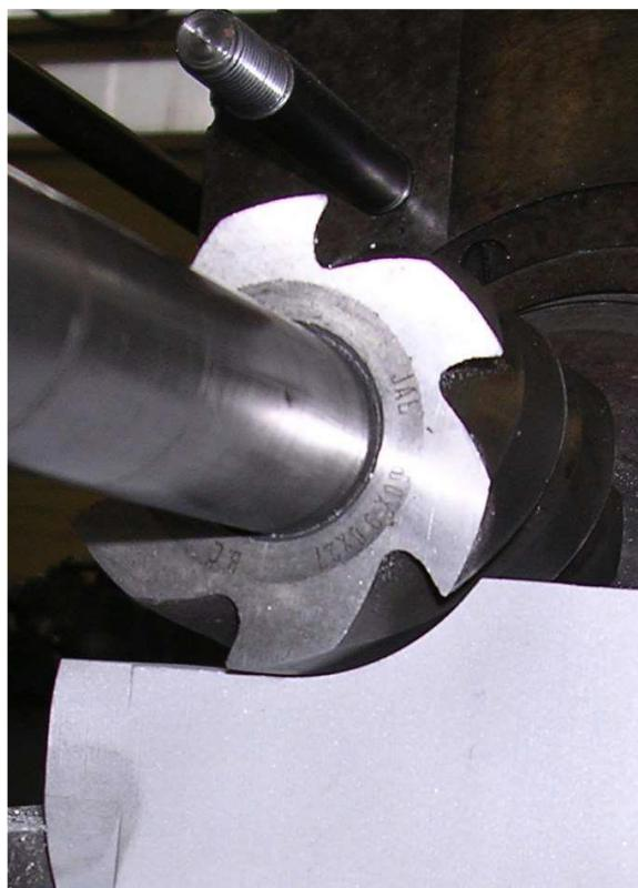
*Slika 2.2 Istosmjerno obodno glodanje [2]*
