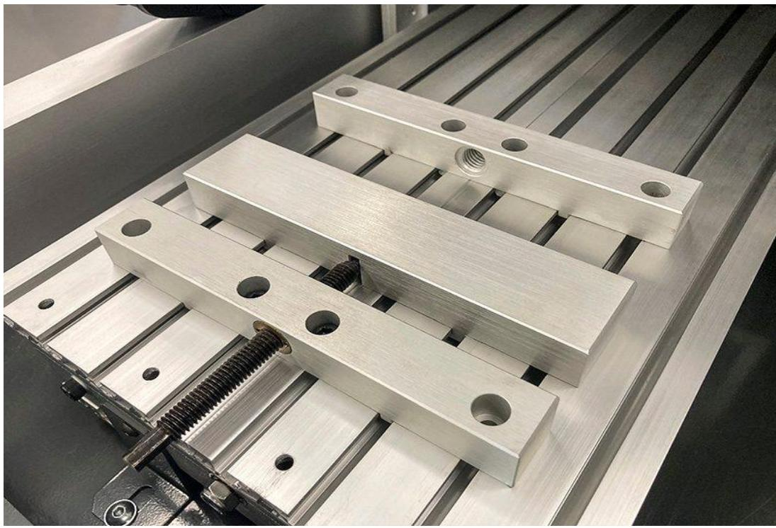
Slika 4.2 Stezna naprava za stezanje obratka [15]
