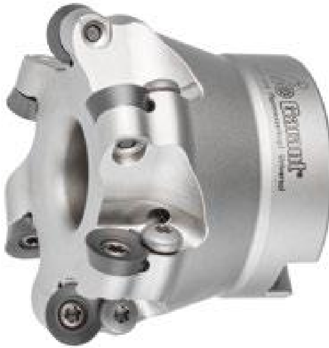
Slika 2.5 Glodaća glava za kopirno glodanje s provrtom [6]
