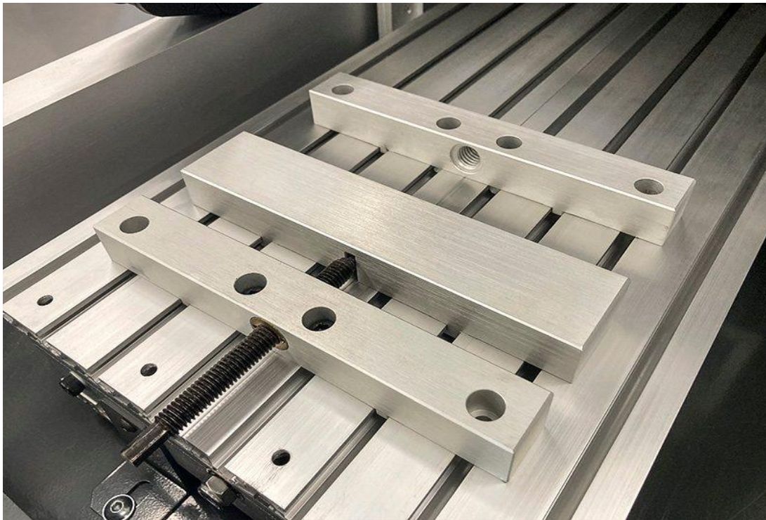
Slika 4.2 Stezna naprava za stezanje obratka [15]
