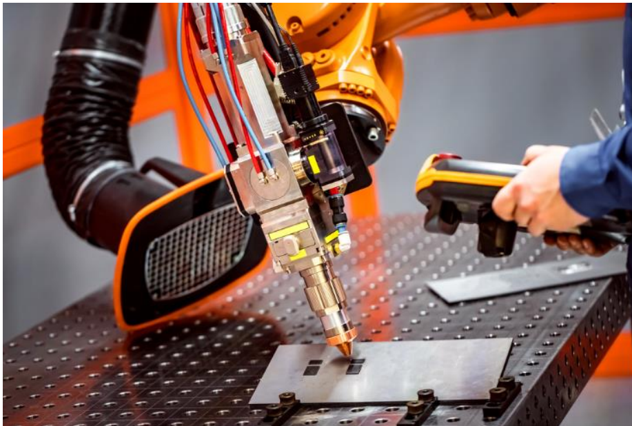
Slika 21. Plazma rezanje robotom [14]
