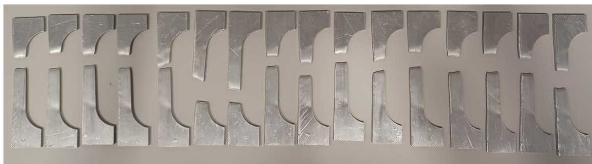
Slika 36. Epruvete nakon ispitivanja [21]
