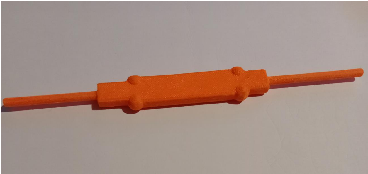
Slika 64. Prototip prvog lijevanog modela sa sferama
