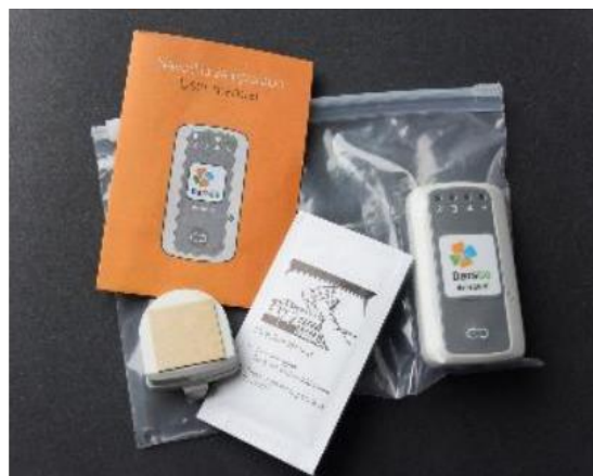
Slika 16. DARS go uređaj za elektroničku naplatu [21]
