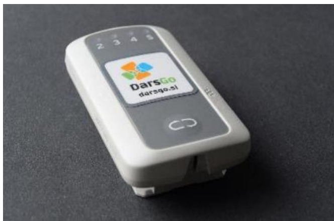
Slika 16. DARS go uređaj za elektroničku naplatu [21]
