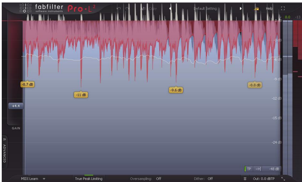
Slika 18. Fabfilter PRO L2 – najpoznatiji digitalni limiter – 11dB limitinga vrhova na finalnom miksu
