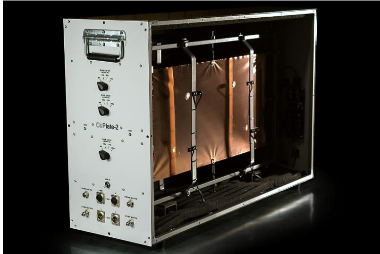
Slika 25. Mehanički pločasti odjek - https://unison.audio/plate-reverb/
