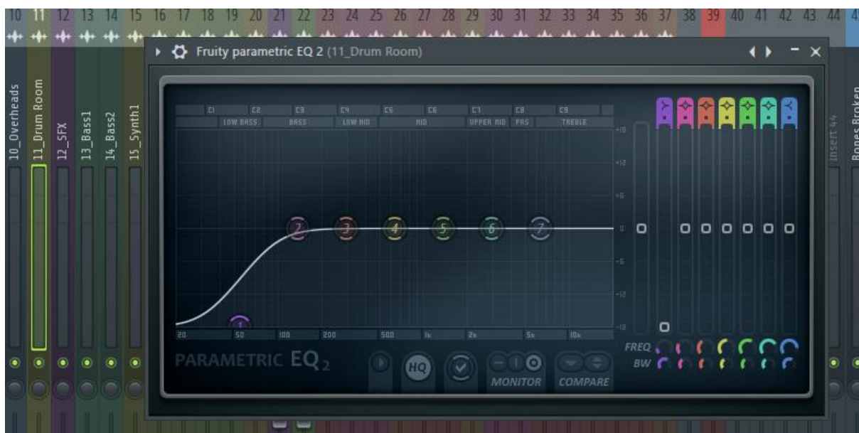
Slika 47. Visokopropusni ekvalizator korišten na audio zapisu bubnjarske sobe
