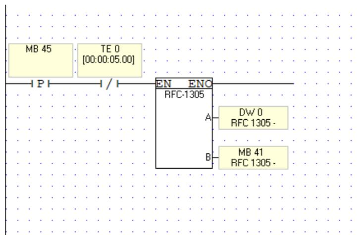
Slika 4.7.5. Dobivanje točnog vremena koristeći NTP
