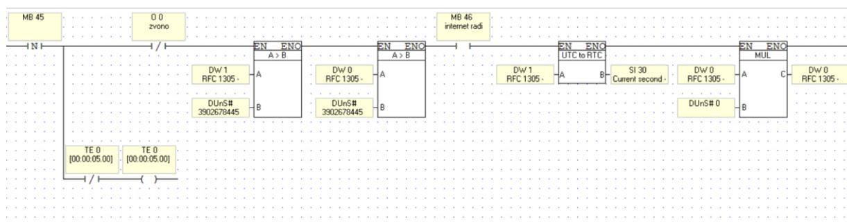
Slika 4.7.6. Upis točnog vremena u unutarnji sat PLC-a
