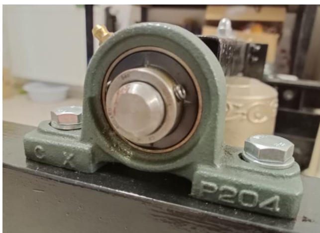
Slika 2.4.1. Samopodesivi kuglični ležaj
