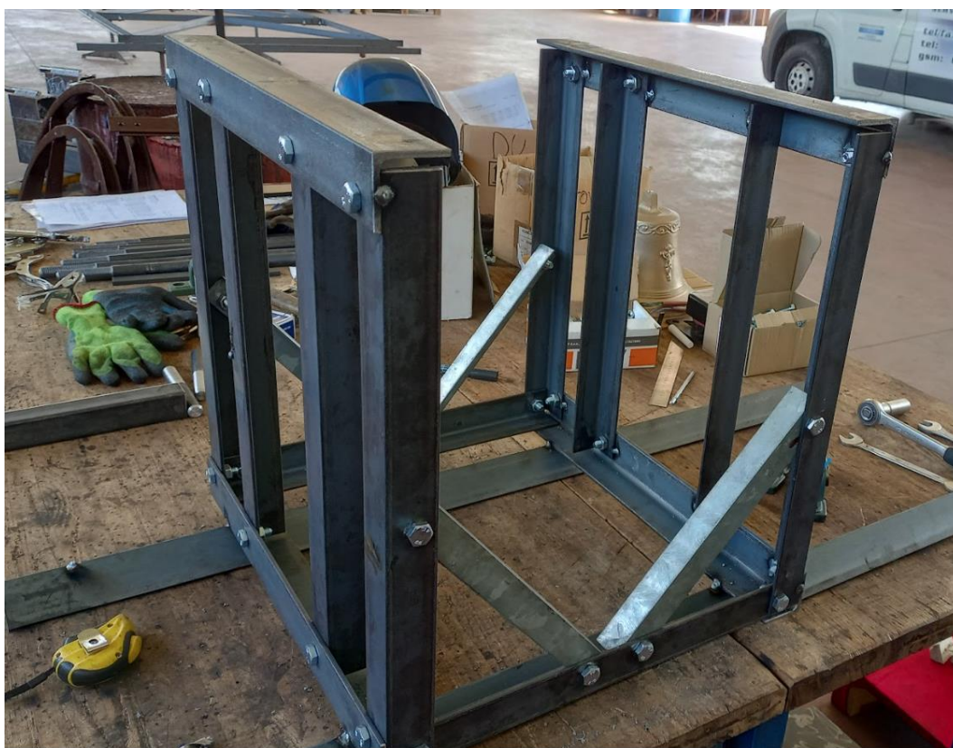
Slika 2.3.1. Izrada postolja za zvono
