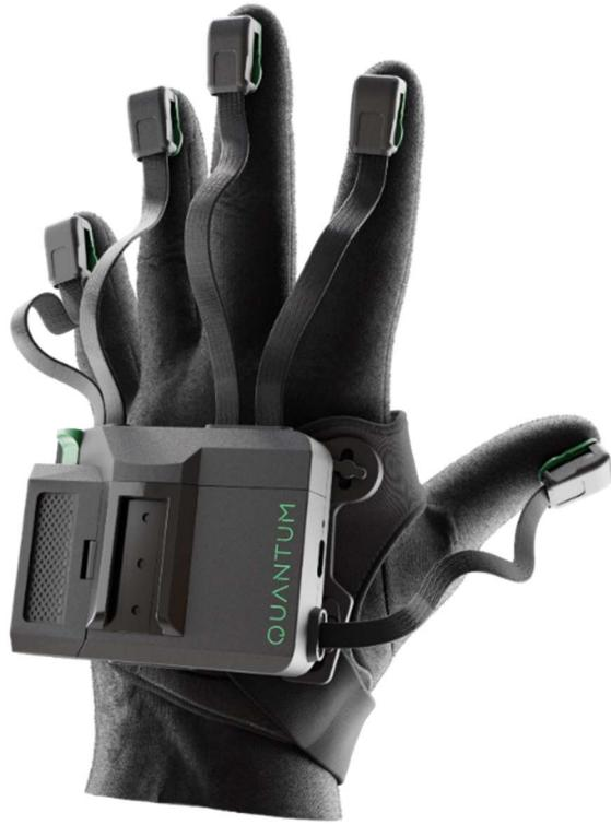
*Slika 2.6 Primjer senzorske rukavice – Quantum Precision XR*
