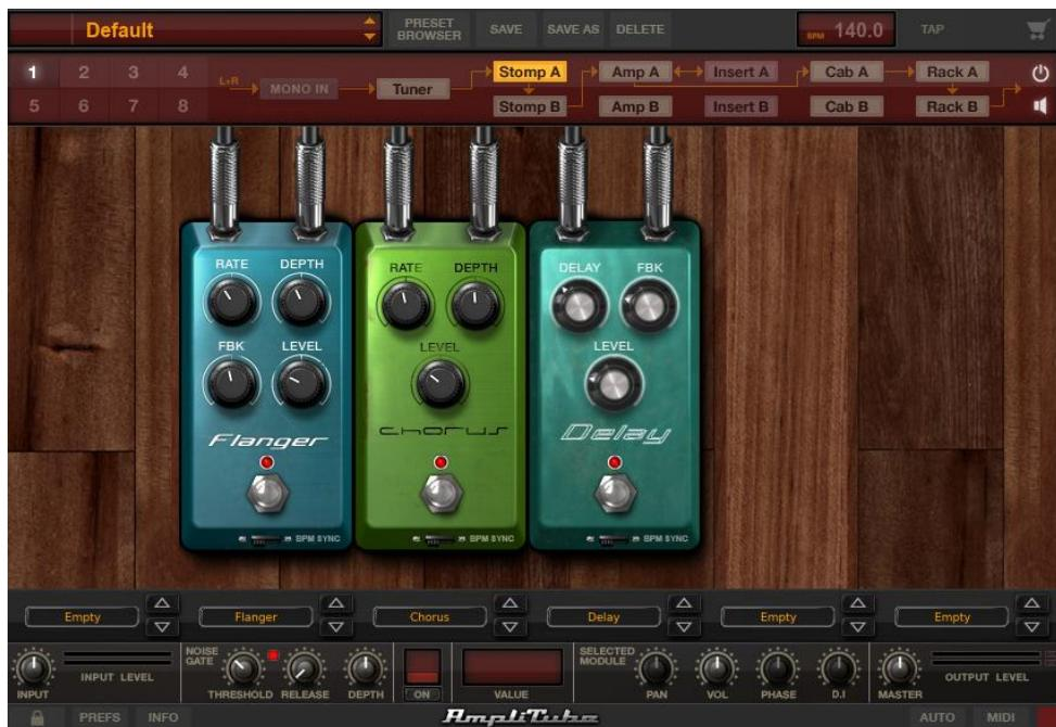
Slika 16. Grafučko sučelje AmpliTube 4, simulacija gitarskog pojačala, efekti
