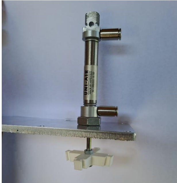
Slika 40. Montaža cilindra i središnje vodilice
