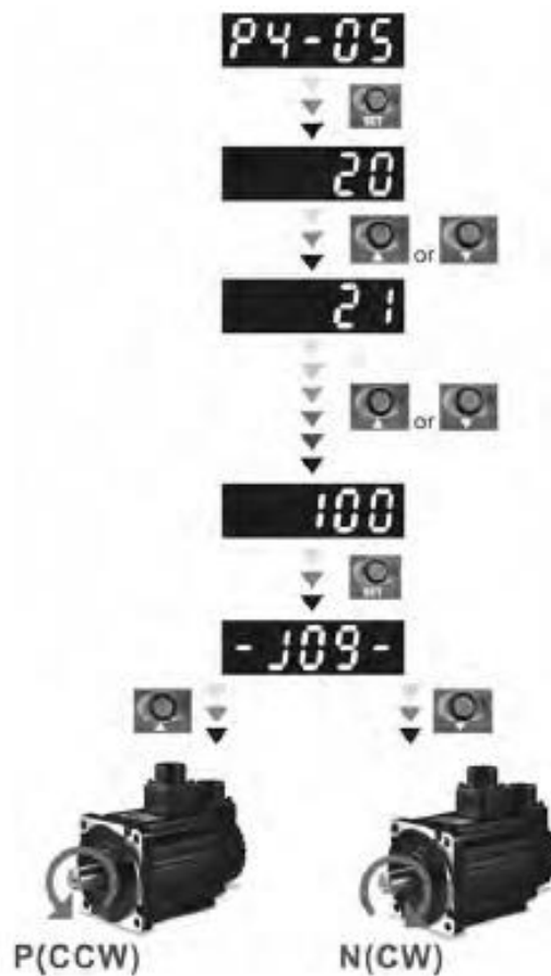
Slika 3.1 JOG motora direktno na servo pogonu [2]
