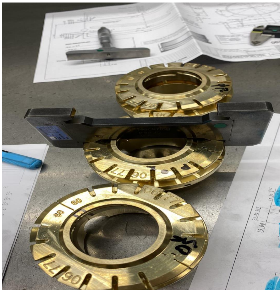
Slika 29. Mjerenje visine prizme kalibrom [28]
