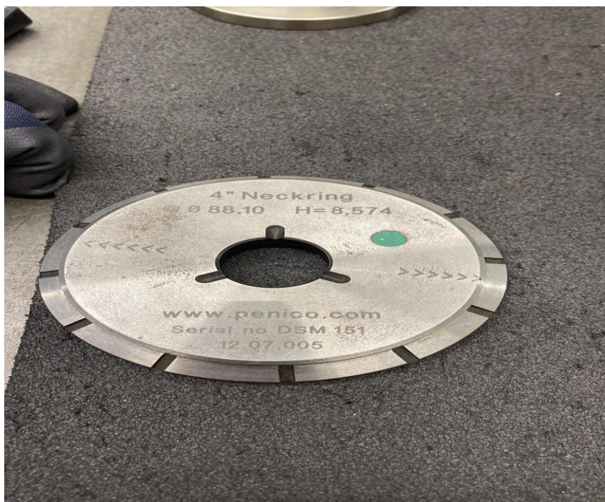
Slika 30. Etalon za provjeru [28]
