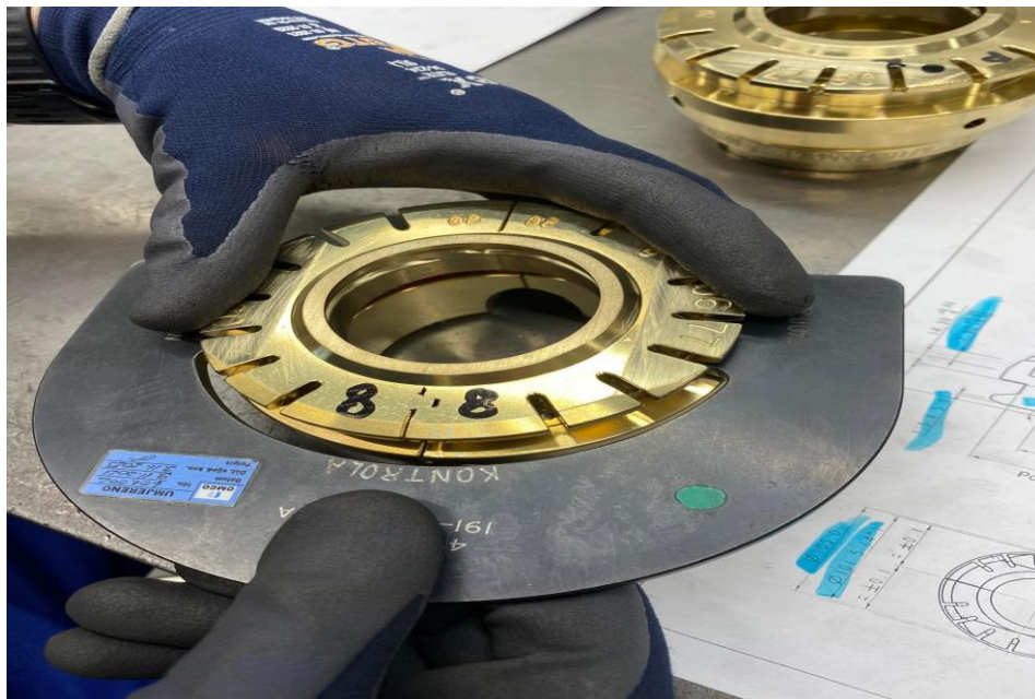
Slika 28. Mjerenje promjera prizme kalibrom [28]
