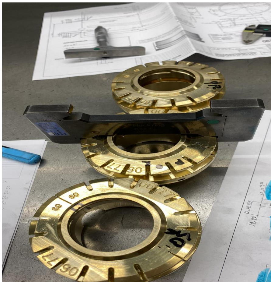
Slika 29. Mjerenje visine prizme kalibrom [28]
