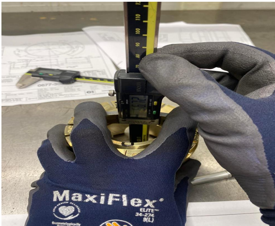
Slika 27. Mjerenje ukupne visine pomičnim mjerilom [28]
