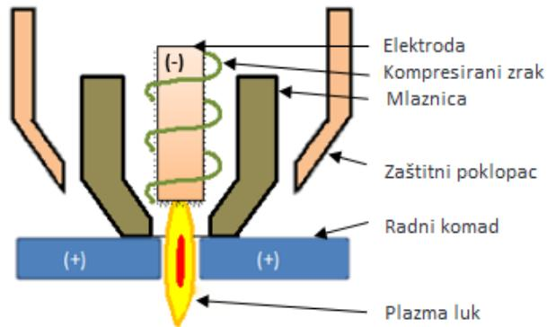
Slika 3.1. Plazma rezanje pomoću komprimiranog zraka [21]
