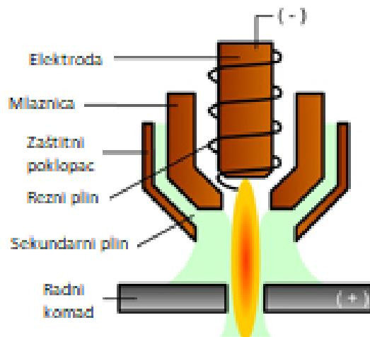
Slika 2.8. Postupak plazma rezanja sekundarnim plinom [8]
