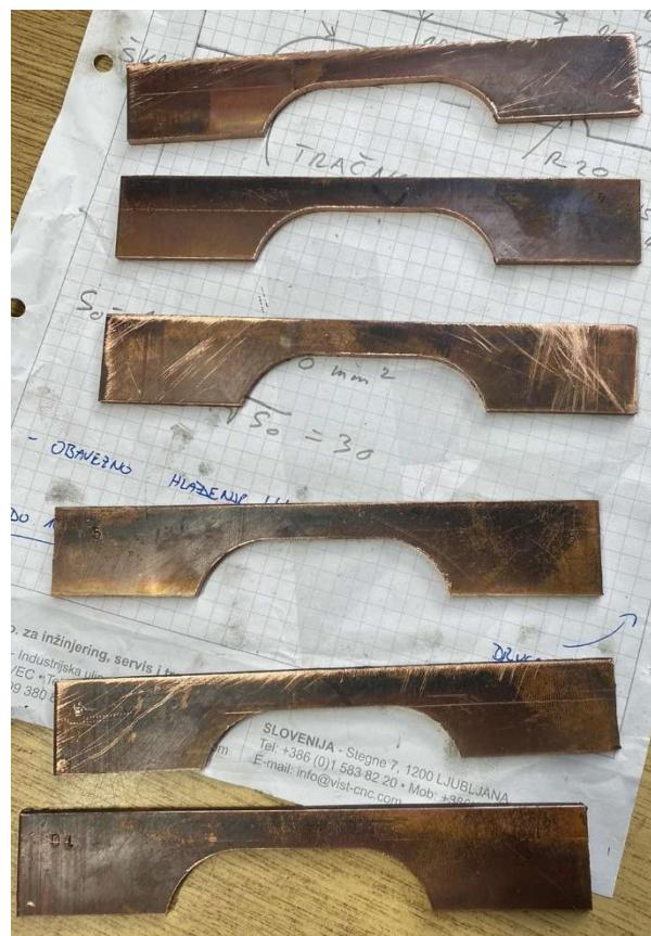
Slika 5.21. Novi uzorci izrađeni strojnom obradom glodanja [36]
