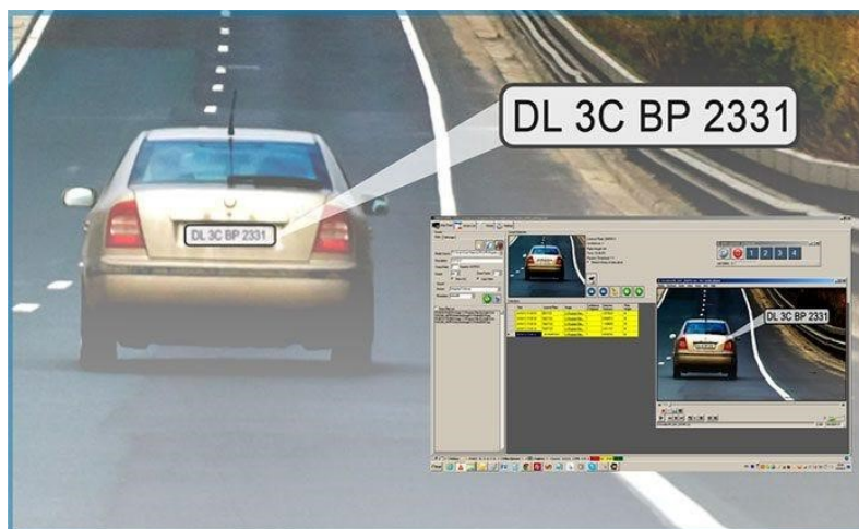
Slika 4.1. Prepoznavanje registarskih pločica automobila, izvor:
