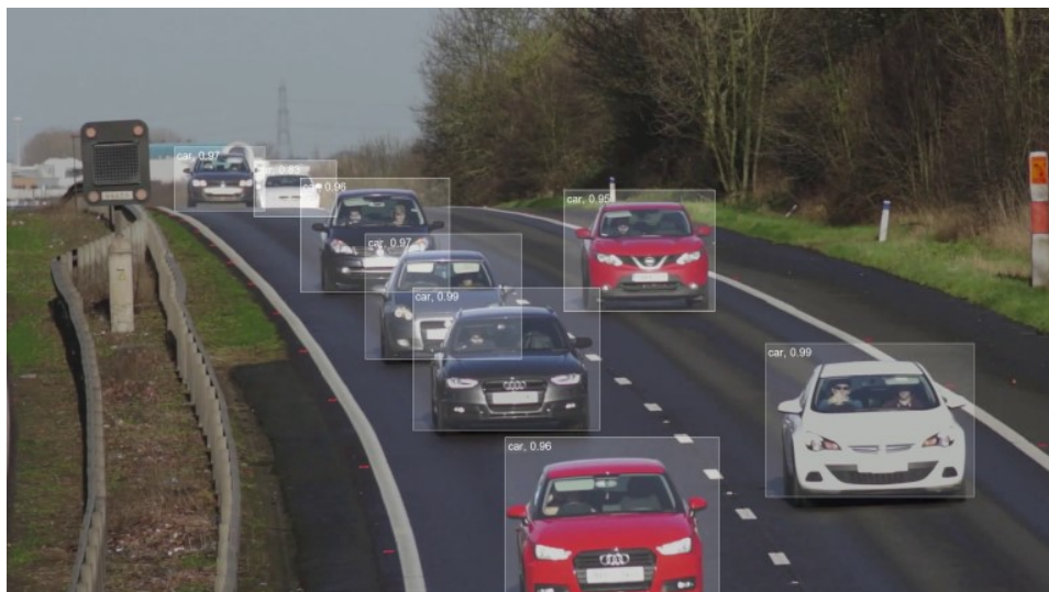
Slika 4.6. Detekcija objekata za vozila temeljena na dubokom učenju, izvor:
