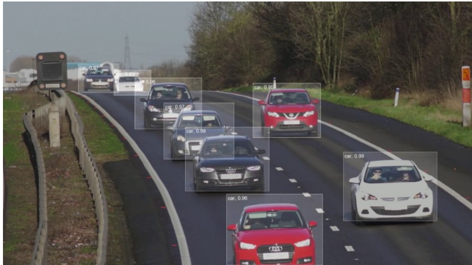
Slika 4.6. Detekcija objekata za vozila temeljena na dubokom učenju, izvor:
