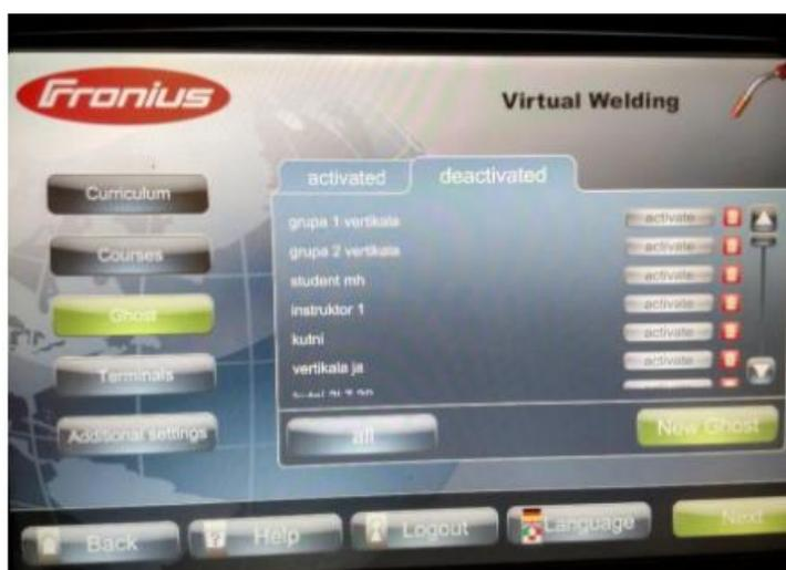
Slika 6.4. Postavljanje novog virtualnog instruktora [13]
