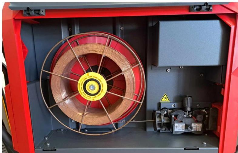
Slika 7.8. Dodavač žice na uređaju za zavarivanje
