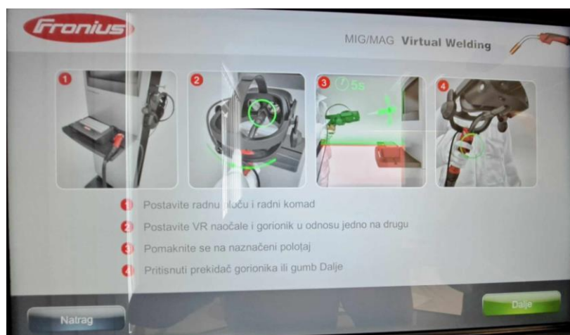
Slika 7.3. Kalibracija prije početka rada
