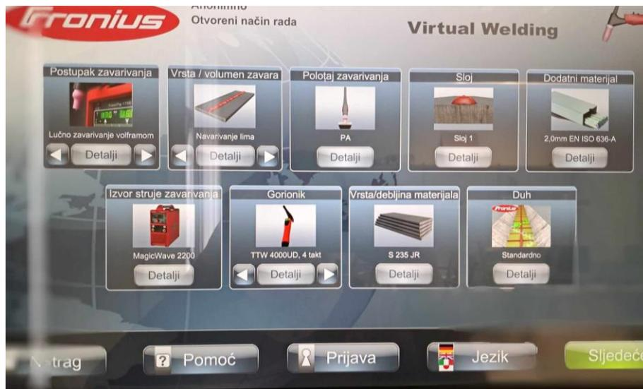
Slika 5.12. Parametri za TIG zavarivanje
