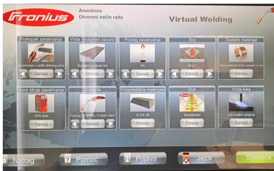
Slika 7.2. Odabrani parametri za MAG zavarivanje
