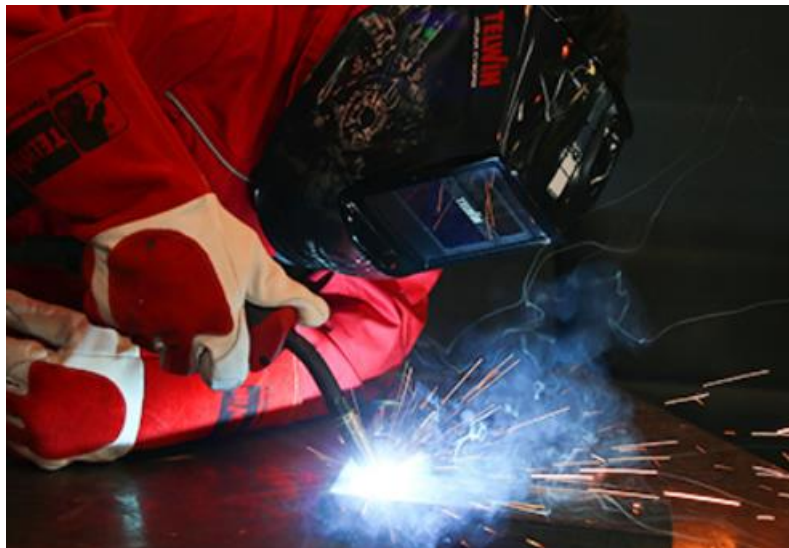
Slika 2.3. Primjer MIG/MAG zavarivanja [2]
