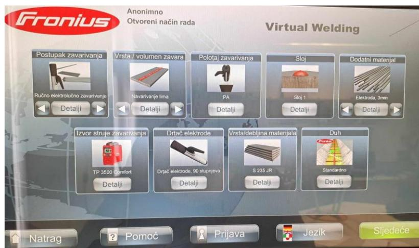
Slika 5.11. Parametri za REL zavarivanje
