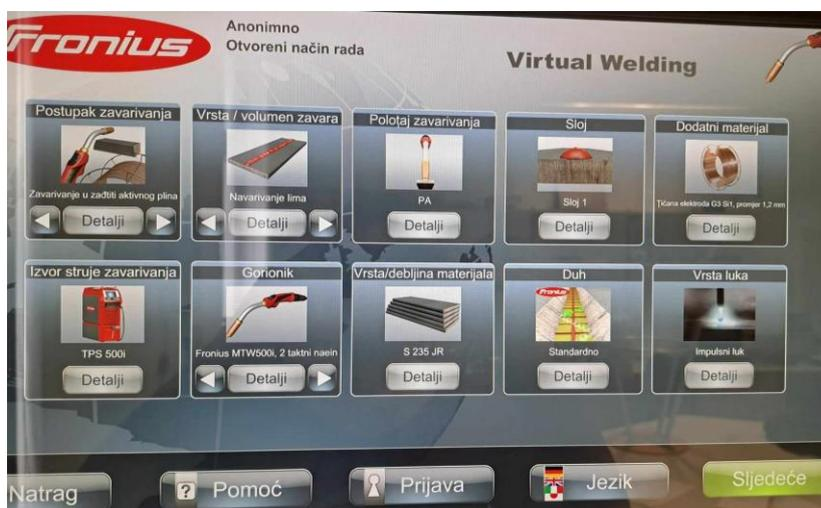
Slika 5.9 Prozor za odabir parametara virtualnog zavarivanja
