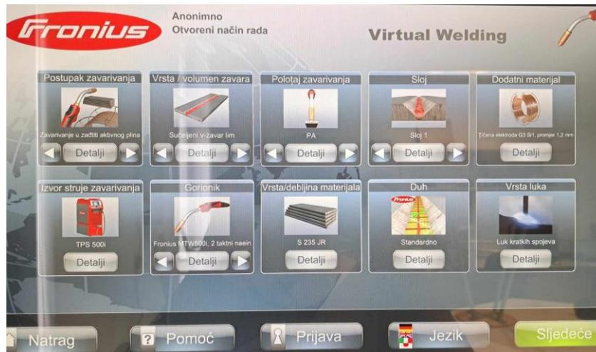
Slika 5.10 Parametri za MAG zavarivanje
