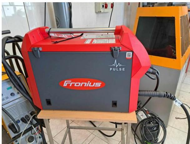
Slika 7.6 Fronius uređaj za zavarivanje
