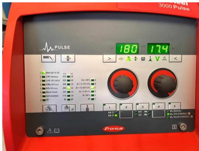
Slika 7.7. Odabrani parametri na uređaju za zavarivanje
