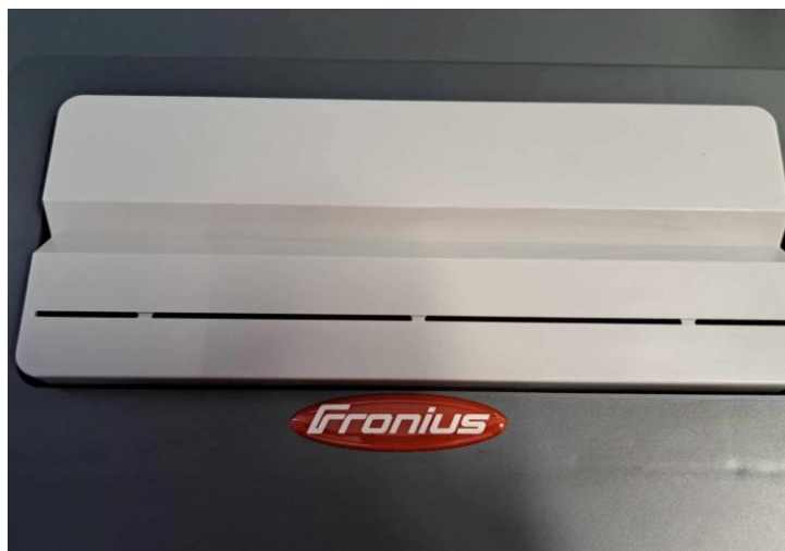
Slika 5.15. Radni komad u PA položaju montiran na držać izratka
