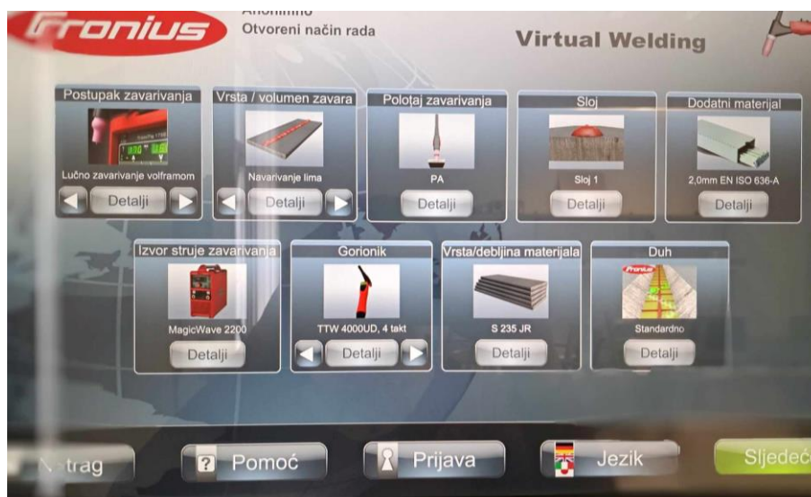
Slika 5.12. Parametri za TIG zavarivanje
