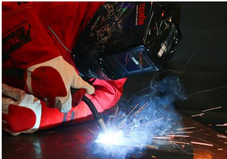
Slika 2.3. Primjer MIG/MAG zavarivanja [2]
