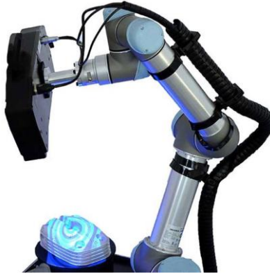
Slika 9 Robot s senzorom za 3D skeniranje [17]
