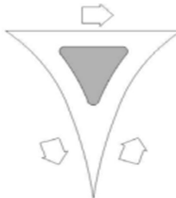
Slika 36. Usmjeravajući otok trokutastog oblika [17]
