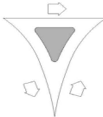
Slika 36. Usmjeravajući otok trokutastog oblika [17]
