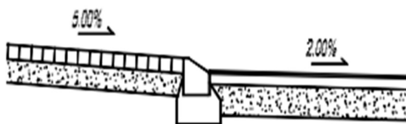
Slika 74. Rubnjak između kružne trake i voznog dijela središnjeg prometnog otoka [17]
