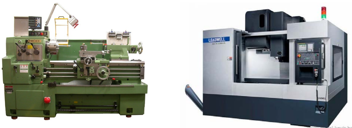
Slika 21. Klasična tokarilica (lijevo) [24] i moderan obradni centar (desno) [25]
