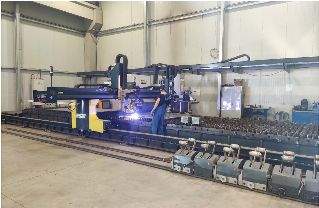
Slika 26. Proces plazma rezanja na stroju Soitaab Impianti SRL [28]
