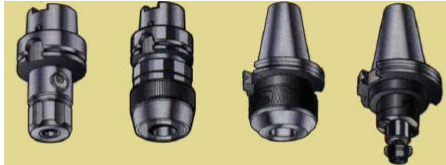
Slika 22. Prikaz HSK (lijevo na slici) i Sk (desno na slici) držača alata [23]
