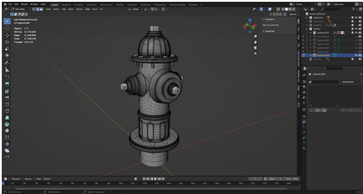
Slika 3.36 Prikaz topologije 3D print modela
