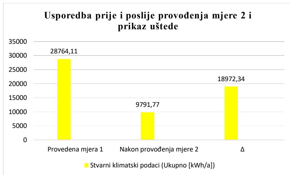
Nakon provedene mjere 2 (uključujući mjeru 1) godišnja ušteda prema stvarnim klimatskim podacima je  **$\Delta=18972,34 \text{ [kWh/a]}$**  (tablica 24) te uz jediničnu cijenu plina **0,0598 €/kWh** ušteda iznosi **1134,55 €**
