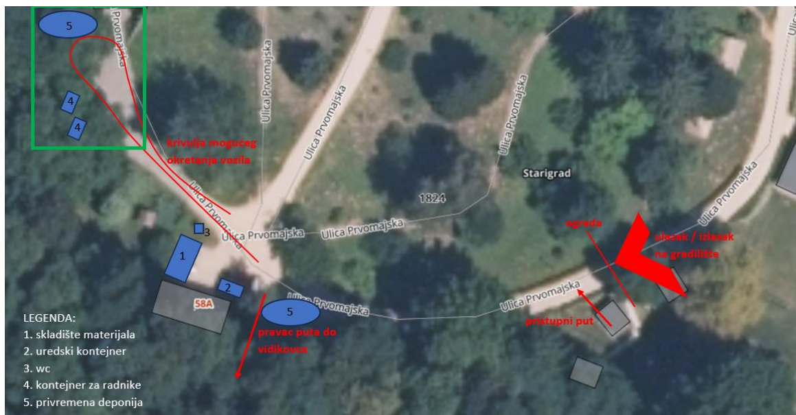
Slika 10.16. Shema uređenja gradilišta
