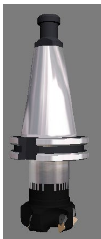
Slika 3.3 Čeono glodalo promjera 63 mm [2]
