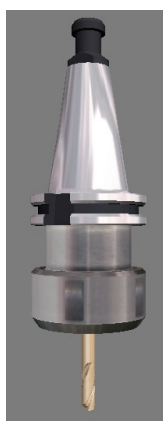
Slika 3.5 Alat za glodanje utora promjera 10 mm [2]
