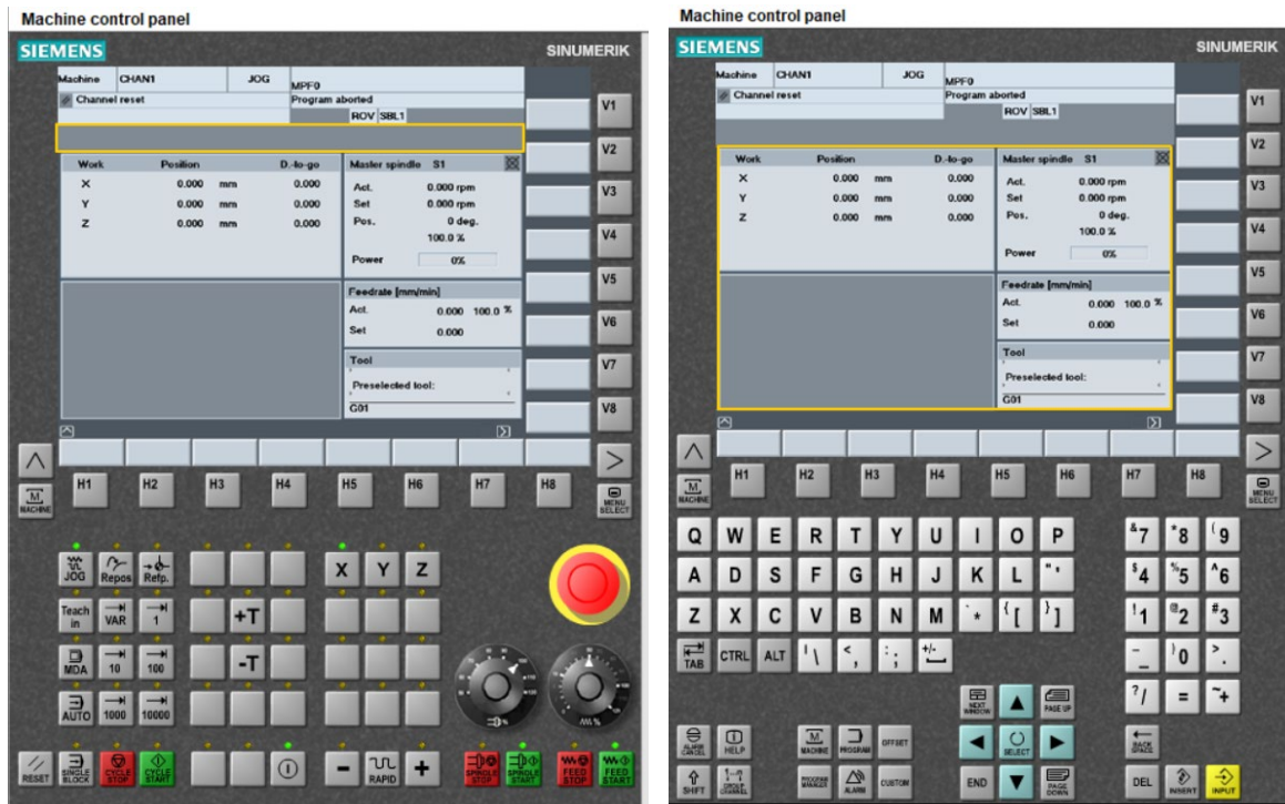
Slika 3.14 Prikaz grafičnog sučelja Siemens SINUMERIK [3]
