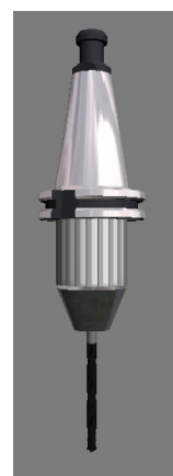
Slika 3.6 Alat za bušenje promjera 8.5 mm [2]
