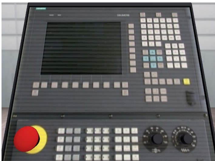
Slika 1.2 CNC upravljačka jedinica Siemens Sinumerik 840D [3]
