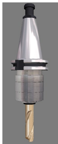
Slika 3.4 Alat za glodanje utora promjera 20 mm [2]
