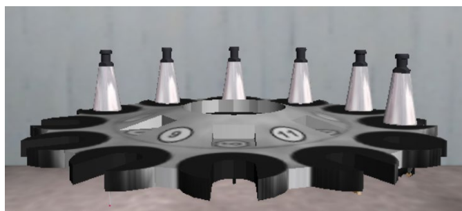
Slika 3.12 CAD model nosača alata – revolvera [3]
