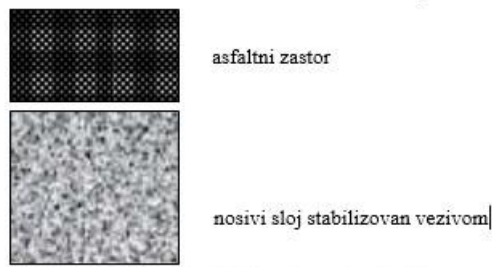
Slika 4.19: Asfaltna kolnička konstrukcija sa nosivim slojem od kamenog agregata stabiliziranog bitumenom ili cementom (Žmavc, 2005)
