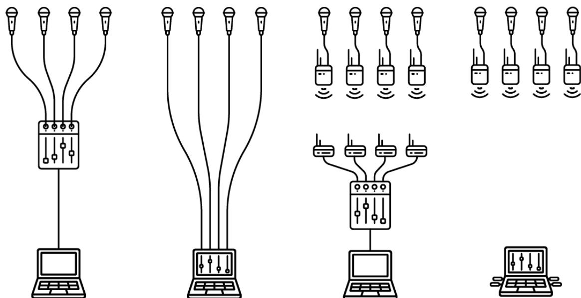
Slika 4.12: Klasična postava (indirektna)
