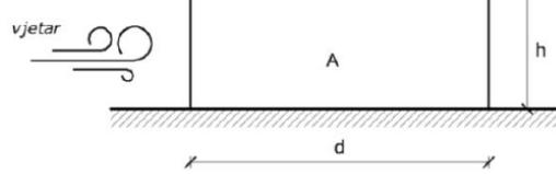
Slika 2.4.3. Sheme područja na koje djeluje vjetar za zgrade s ravnim krovovima i pravokutnim tlocrtima (Priručnik s tablama i izrazima za proračun djelovanja na konstrukcije)[3]
