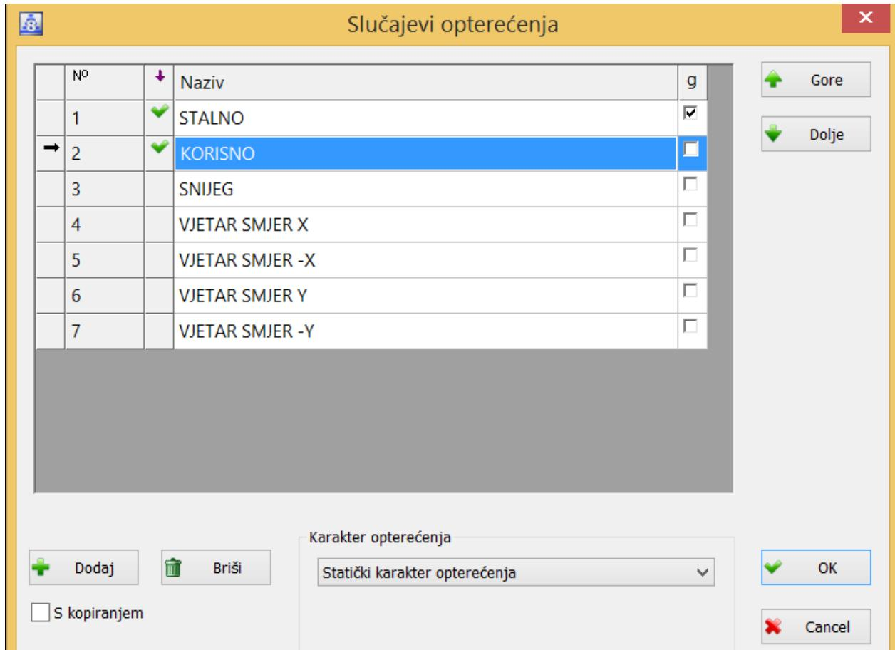
Slika 4 Prikaz slučajev opterećenja (snimka zaslona u programu TOWER)
