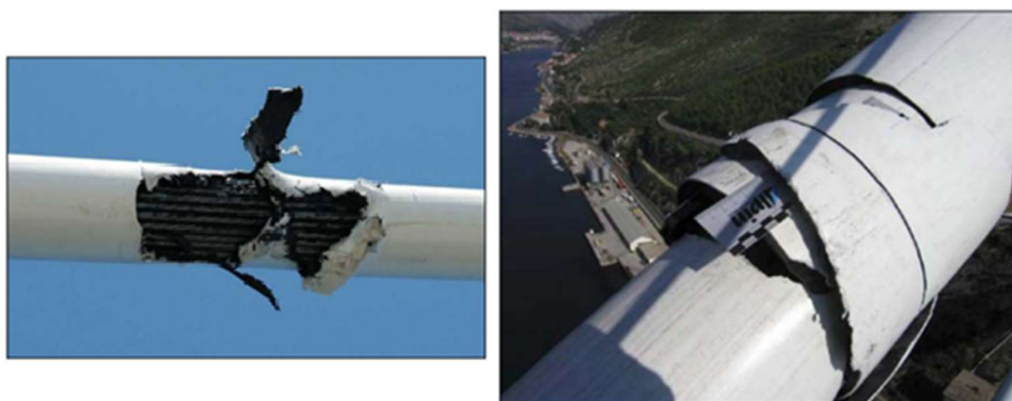
Slika 6: Oštećenje zaštitne cijevi
