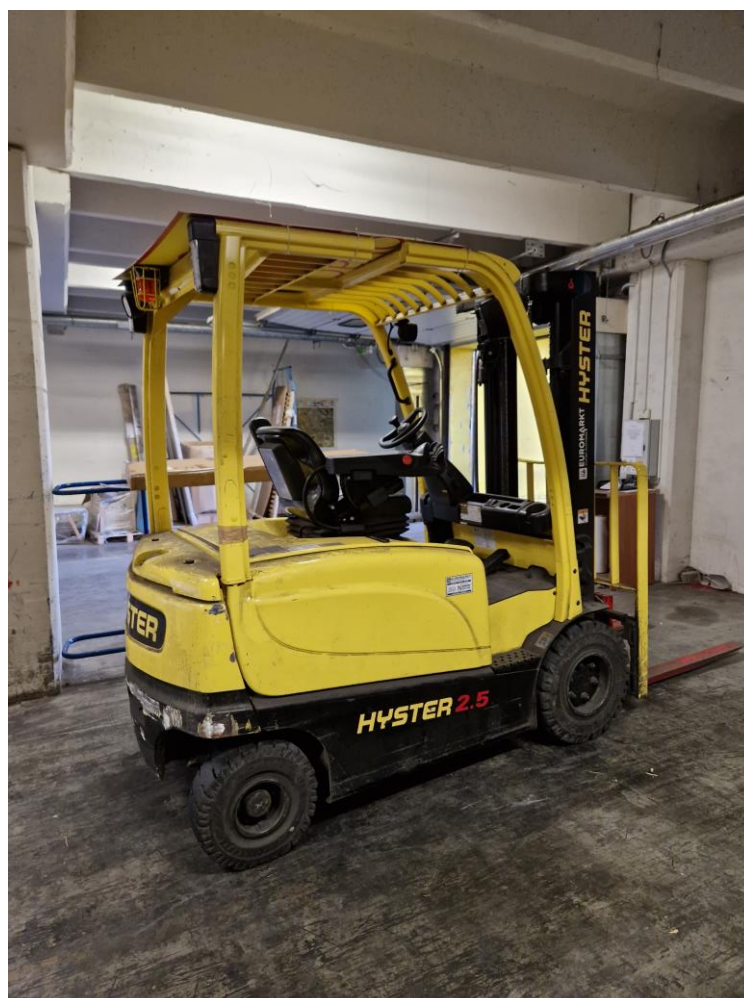
Slika 4. 10 Primjer električnog čeonog viličara u PJ Lesnina Varaždin
