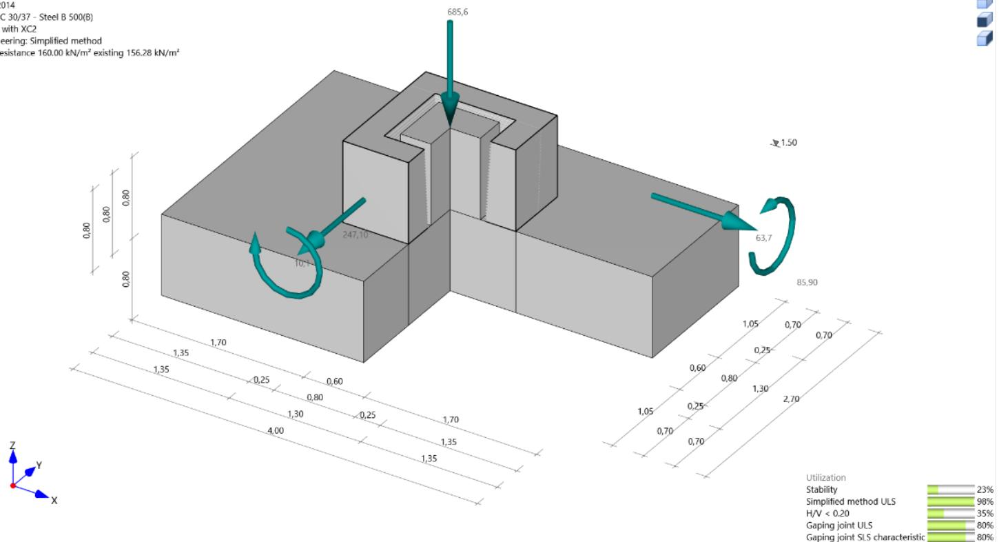
Slika 5.11 Odabir finalne geometrije zaokruživanjem na veću dimenziju
