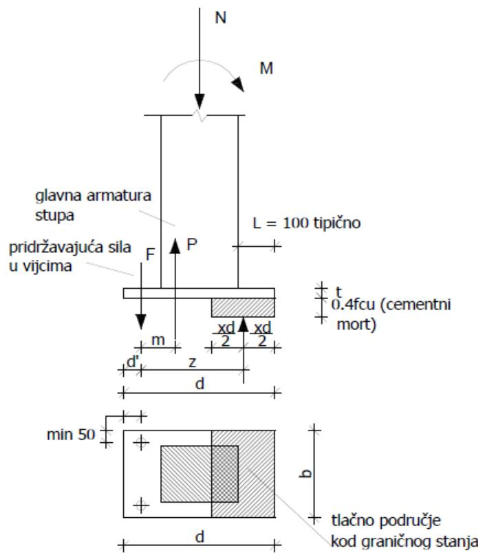
Slika 2.5 Prikaz proračuna produljene ležajne ploče [1]
