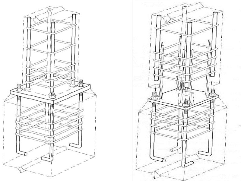
Slika 2.8 Temeljenje na čeličnoj ploči: većeg poprečnog presjeka od stupa (lijevo) i jednakog poprečnog presjeka kao stup (desno) [2]
