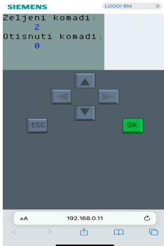
Slika 37 Virtualni prikaz zaslona LOGO! logičkog modula - mobilni uređaj
