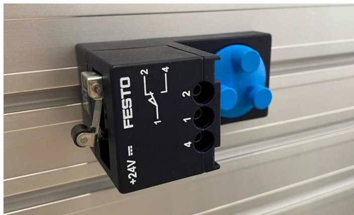
Slika 16 Granični prekidač s desna (183345)
