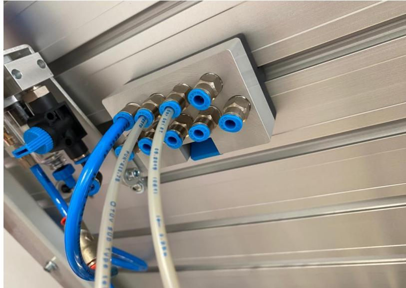
Slika 14 Dovod zraka u pneumatske komponente
