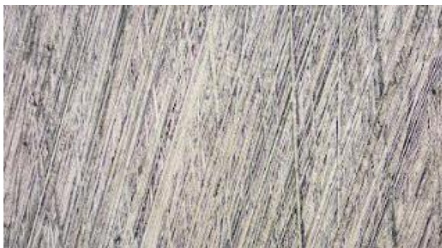
Slika 39 - Neprihvatljiva površina nakon brušenja
