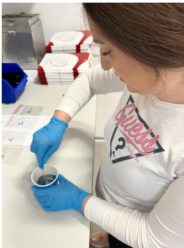
Slika 32 - Pripremanje polimerne mase
