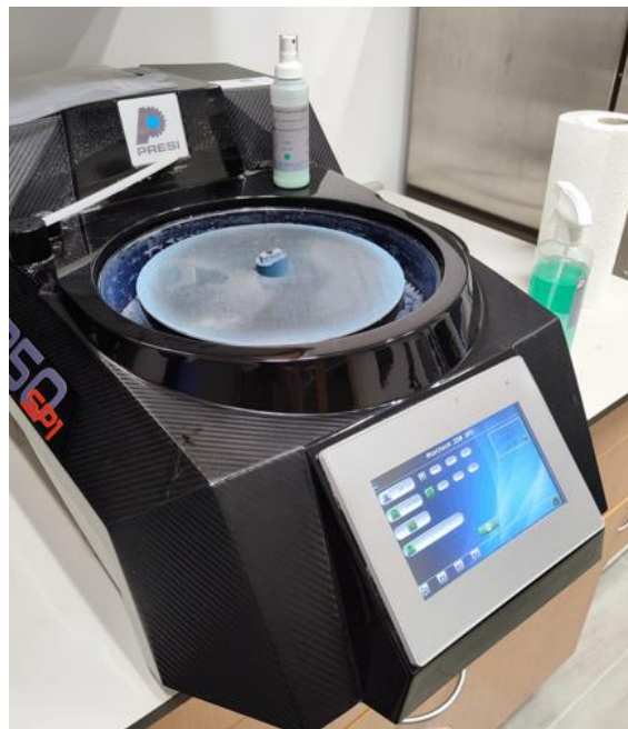
Slika 42 - Poliranje s 3 \mu\text{m}
