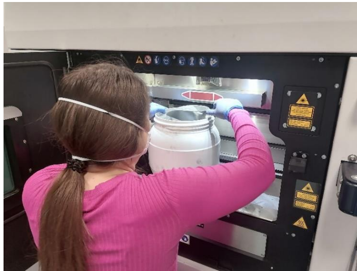
Slika 21 - Punjenje spremnika prahom
