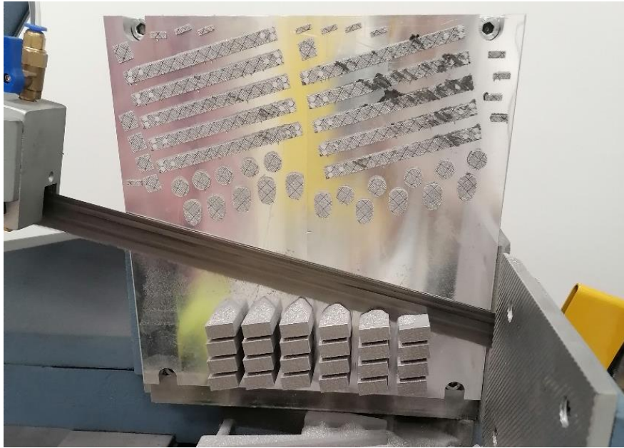
Slika 30 - Odvajanje komada pilom
