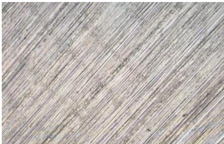
Slika 38 - Prihvatljiva površina nakon brušenja
