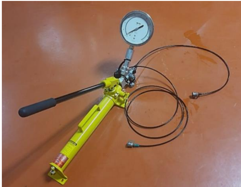
Slika 13. Hidraulični sustav za nanošenje tlaka [6]
