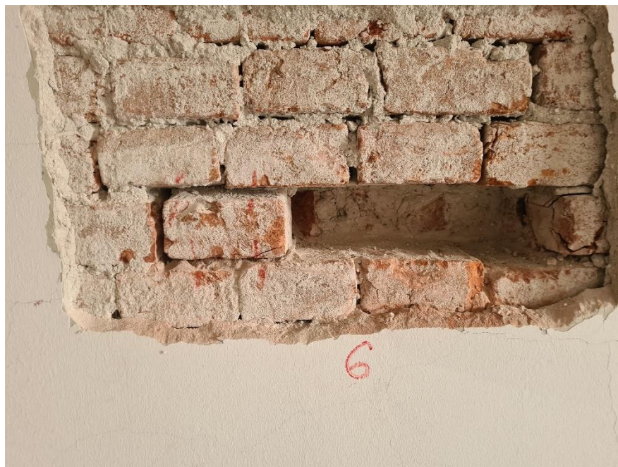
Slika 7. Prikaz uklonjene opeke prije početka ispitivanja
