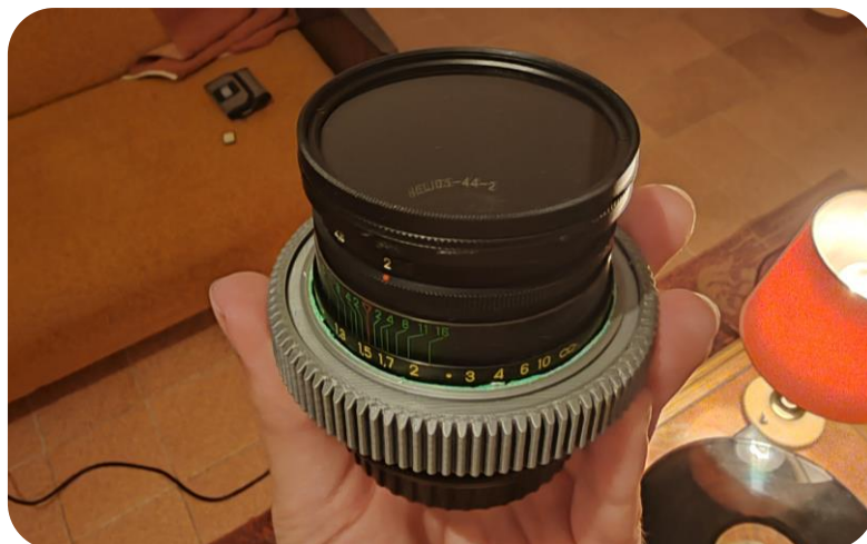
Slika 14. Helios 44-2 objektiv s 3D printanim prstenom fokusa na setu
