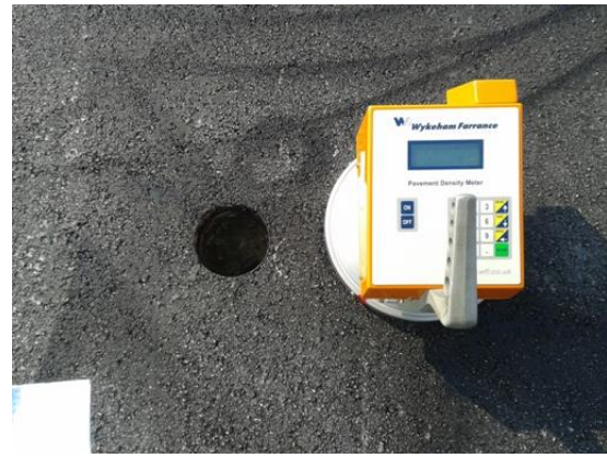
Slika 67. Mjerenje zbijenosti neraznom metodom na mjestu bušenja (usporedba rezultata)
