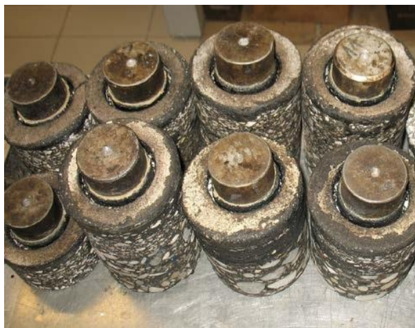
Slika 87. Uzorci za ispitivanje povezanosti
