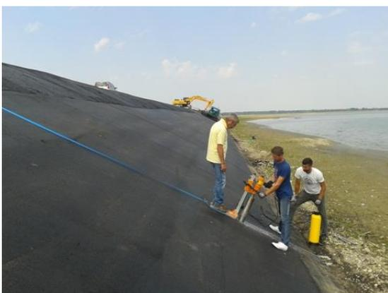
Slika 58. Uzorkovanje uzoraka iz ugrađenog asfaltnog sloja bušenjem
