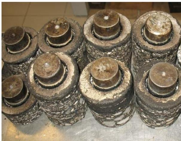
Slika 87. Uzorci za ispitivanje povezanosti
