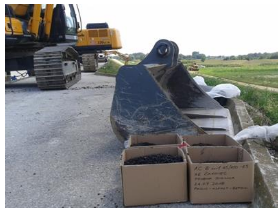
Slika 53. Uzorci asfaltnih mješavina uzorkovani u sklopu kontrolnih ispitivanja
