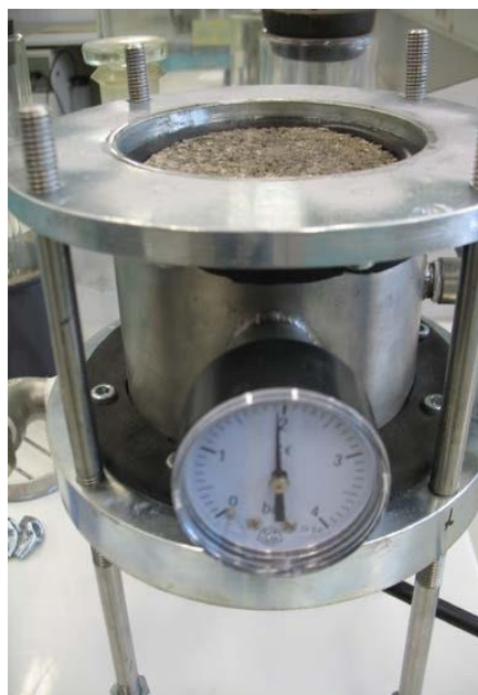
Slika 91. Bočno brtvljenje uzorka (2 bara)
