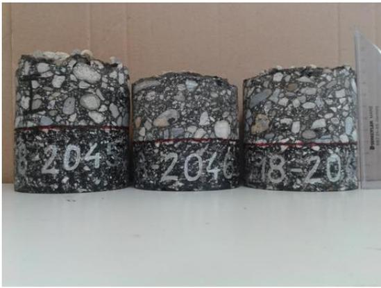
Slika 60. Izvađeni uzorci iz ugrađenog asfaltnog sloja (vodonepropusni + nosivi sloj)
