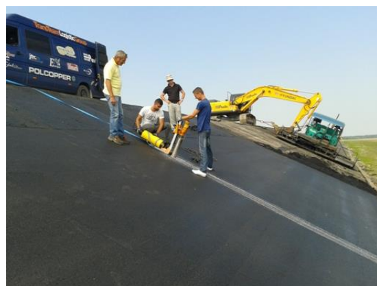
Slika 59. Uzorkovanje uzoraka iz ugrađenog asfaltnog sloja bušenjem
