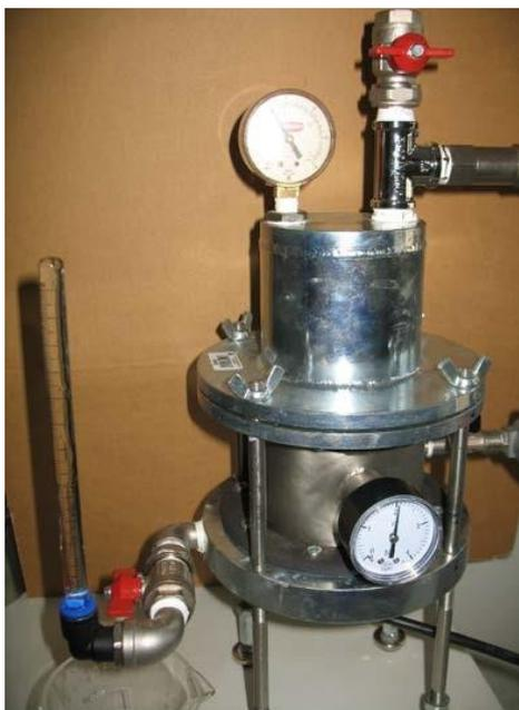
Slika 90. Uređaj za određivanje vodopropusnosti
