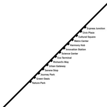
Slika 35 - 19. način: koso rastuća linija pod 45°, imena stanica usporedna s dijagramom i desno od linije
