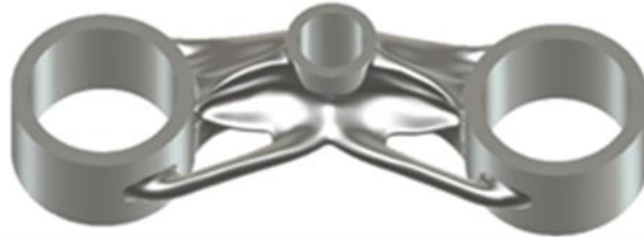
Slika 4.2.5-4 Primjer ishoda za opciju "3-osno glodanje"[23].
