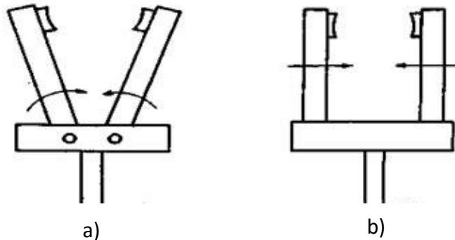
Slika 5-7 Pokreti zatvaranja; a)rotaciono zatvaranje, b)linearno zatvaranje.
