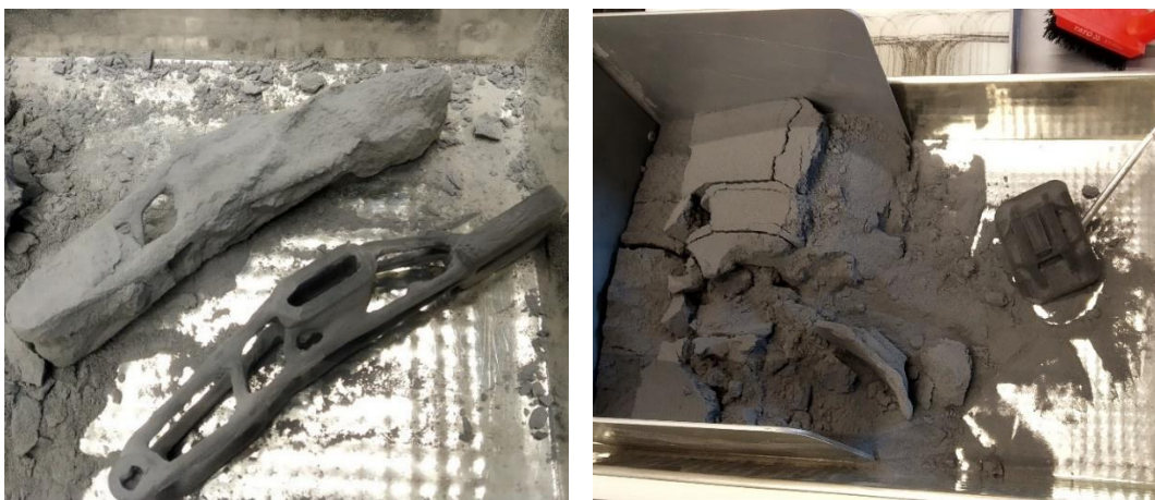
Slika 9-2 Prikaz čišćenja elemenata nakon SLS postupka ispisa.
