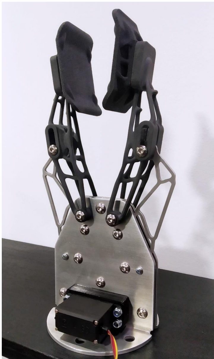
Slika 10-1 Sklopljeni prototip robotske hvataljke.
