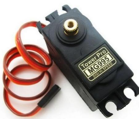
Slika 9.1-1 Servo-motor TowerPro MG995
