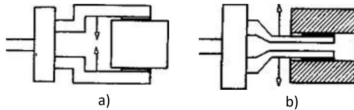
Slika 5-6 Način hvatanja; a)vanjsko hvatanje, b)unutarnje hvatanje.
