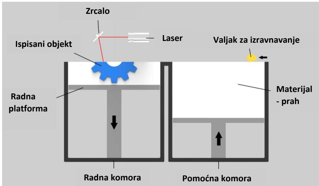
Slika 9.2-2 Princip rada SLS aditivne tehnologije [32].
