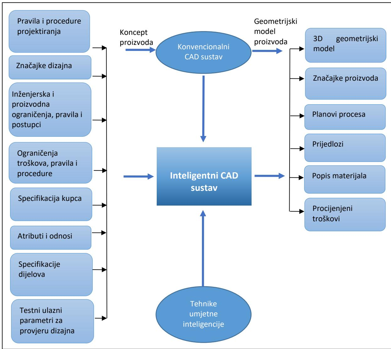
Slika 3.2-1 Integracija konvencionalnog CAD sustava u inteligentni sustav [9].
