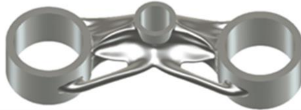
Slika 4.2.5-4 Primjer ishoda za opciju "3-osno glodanje"[23].
