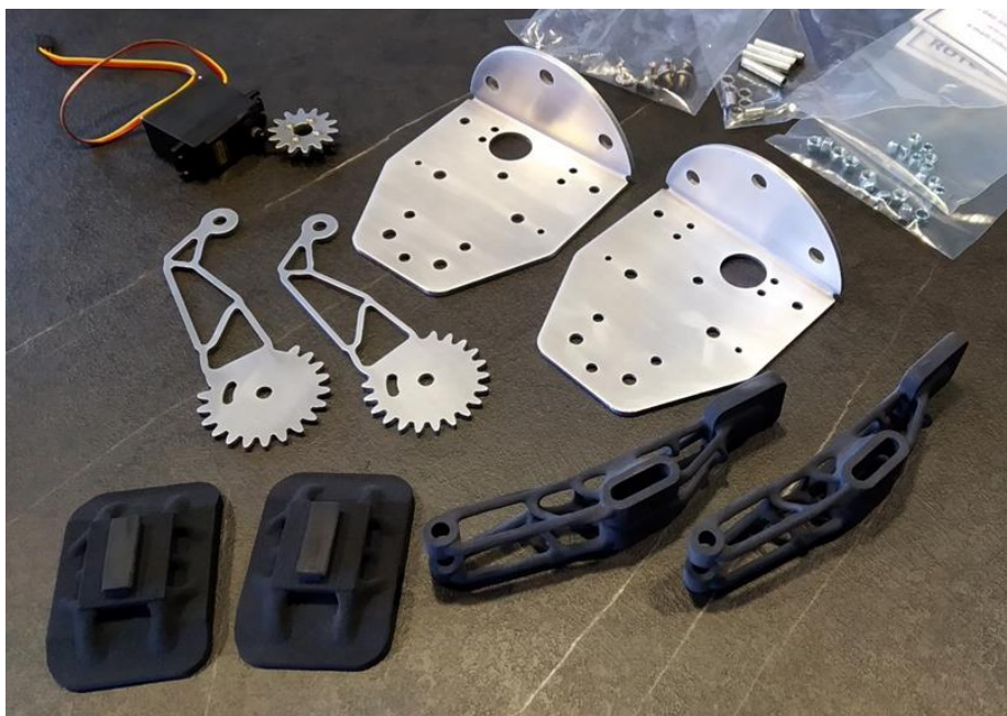
Slika 9-3 Prikaz svih dijelova robotske hvataljke prije sklapanja.
