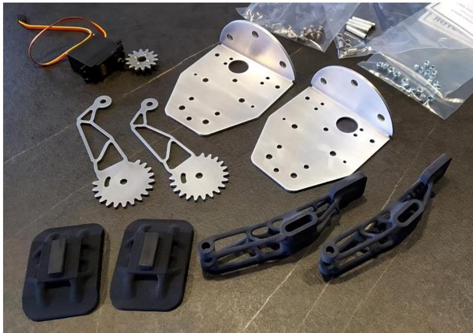
*Slika 9-3 Prikaz svih dijelova robotske hvataljke prije sklapanja.*
