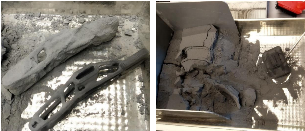
Slika 9-2 Prikaz čišćenja elemenata nakon SLS postupka ispisa.
