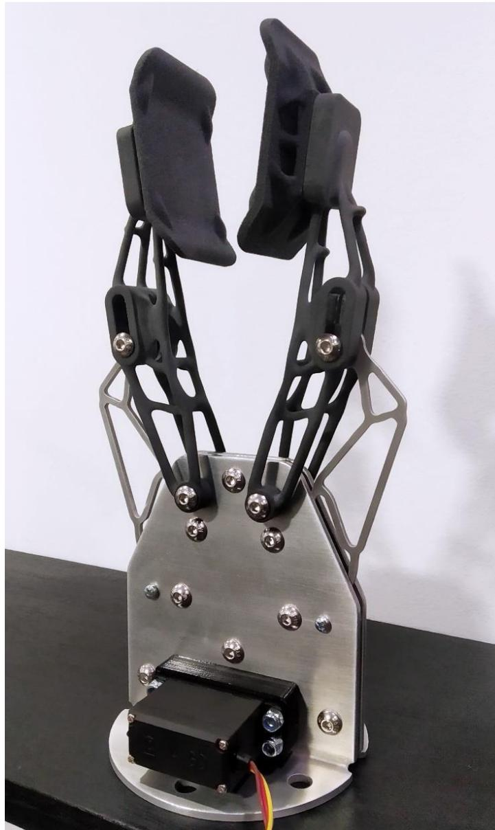
Slika 10-1 Sklopljeni prototip robotske hvataljke.
