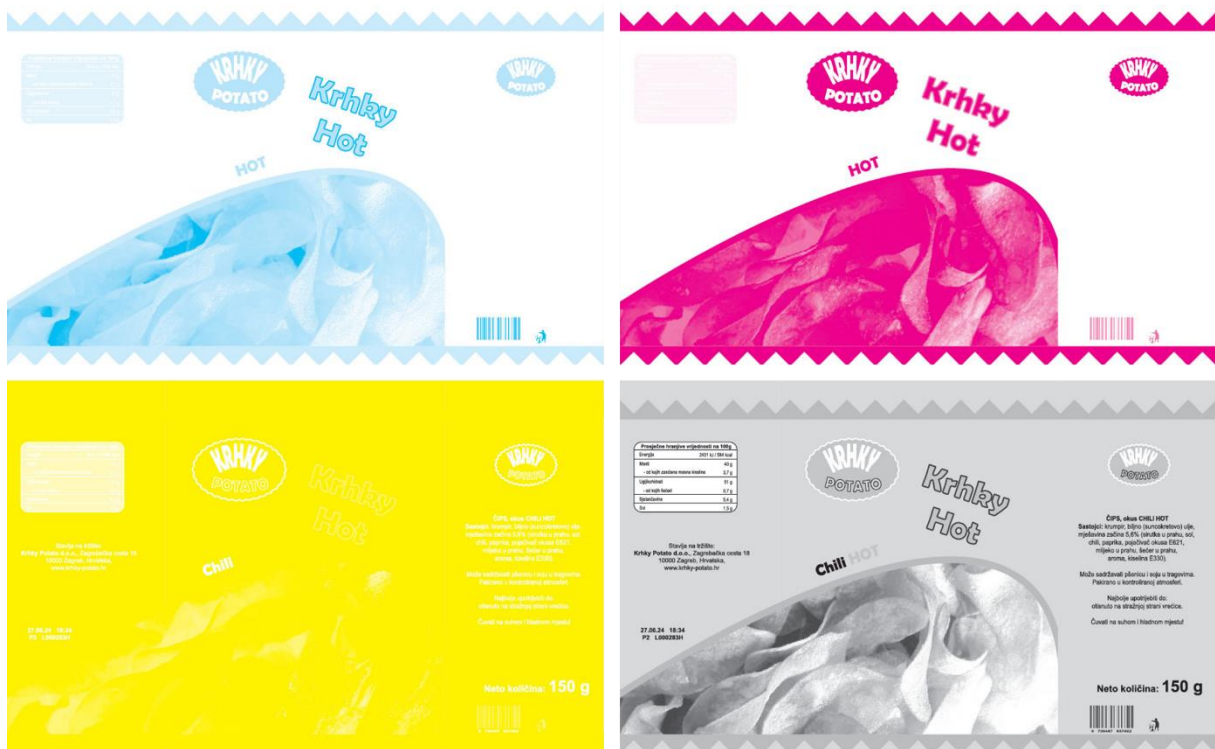
Slika 33. Separacija CMYK boja Autor: M.Milec-Adobe Photoshop
