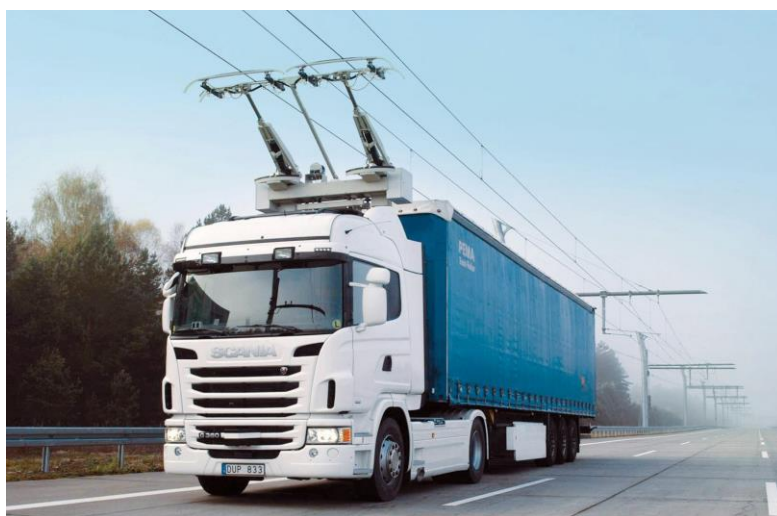
Slika 1. Hibridni kamion s pantografom tvrtke Scania
