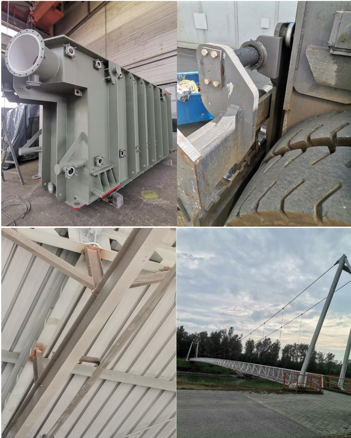
Slika 3.10. Primjeri primjene MIG/MAG postupka [osobne slike]
