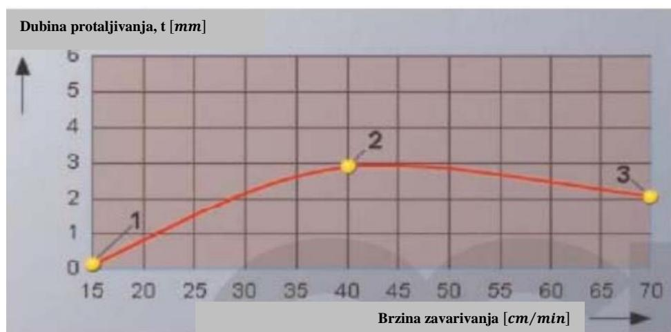
Slika 3.5. Ovisnost dubine protaljivanja o brzini zavarivanja [7]
