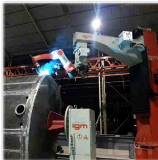
*Slika 4.1. Robotizirani MIG/MAG postupak zavarivanja [9]*
