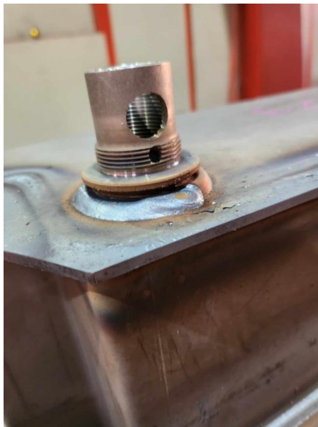
Slika 5.31. Dobiveni zavareni spoj na ispustu [osobne slike]
