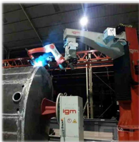
Slika 4.1. Robotizirani MIG/MAG postupak zavarivanja [9]
