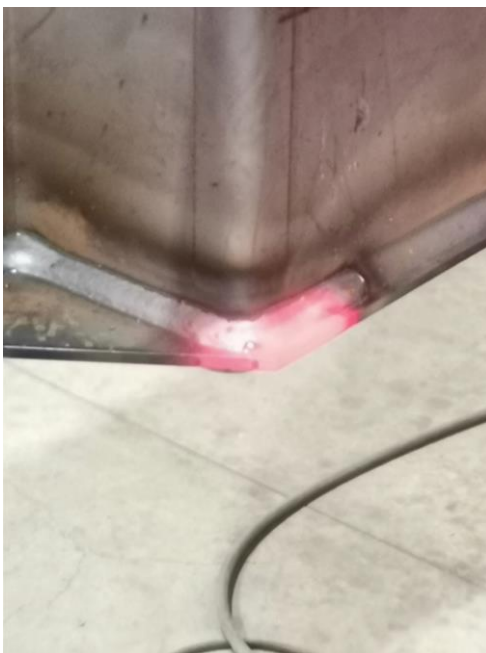
Slika 5.28. Drugi dio zavarenog spoja bočne stranice [osobne slike]
