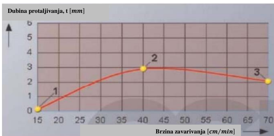
Slika 3.5. Ovisnost dubine protaljivanja o brzini zavarivanja [7]
