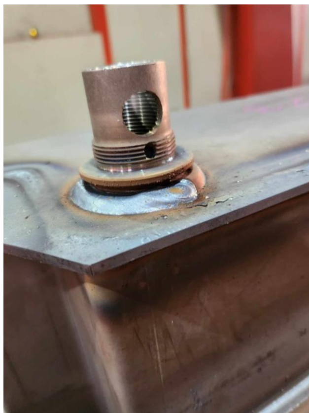
Slika 5.31. Dobiveni zavareni spoj na ispustu [osobne slike]
